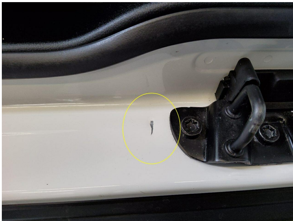
Bild 16 : Türeinstieg hinten links, zerkratzt und geknagelt
