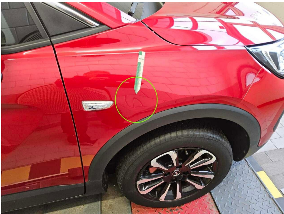
Bild 28 : Kotflügel vorne rechts, mehrfach eingedellt, drücken
