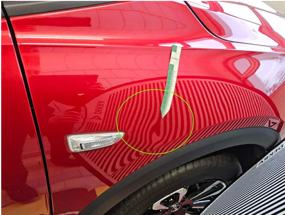
Bild 29 : Kotflügel vorne rechts, mehrfach eingedellt, drücken
