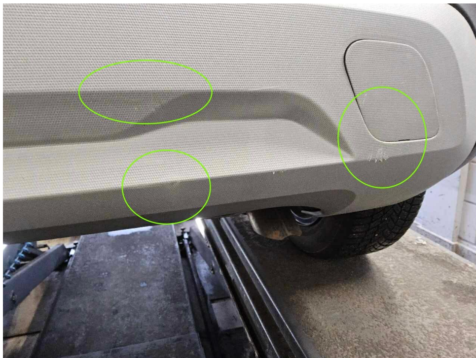
Bild 22 : Diffusor hinten verschrammt
