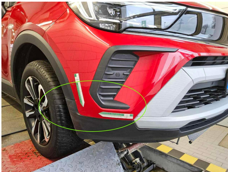
Bild 13 : Stoßfänger vorne Lackierung, verschrammt, smart repair
