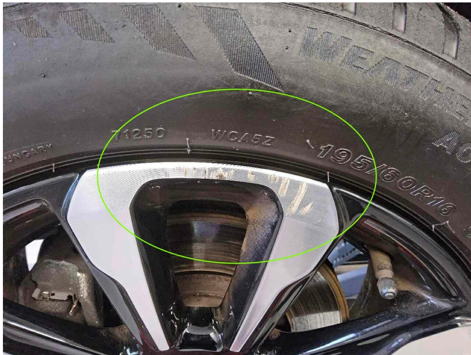
Bild 33 : Alufelge glanzgedreht vorne links verschrammt mit Materialabtrag
