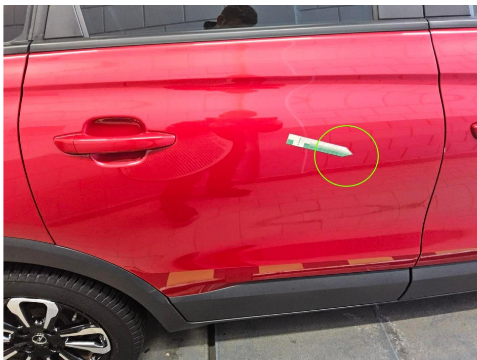
Bild 24 : Tür hinten rechts, deformiert, instandsetzen und lackieren mit Lackaufbau
