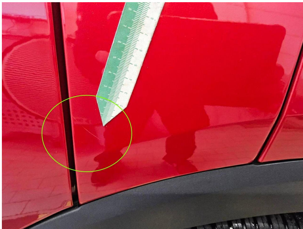
Bild 18 : Seitenteil hinten links Lackierung unterhalb, zerkratzt, smart repair
