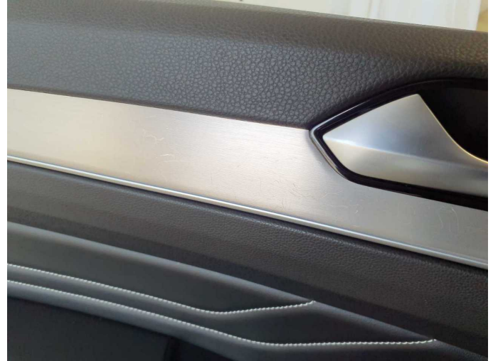
Damage 3: Trim / covers: Door trim - front left side (Zierleiste) - Scratch(es) - Loss in value
