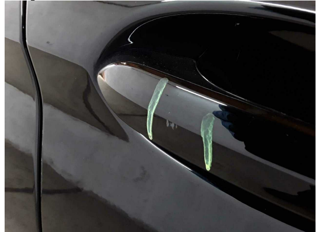
Beschädigung #2: Tür vorn rechts: Griff außen - verkratzt / verschürft - Smart Repair
