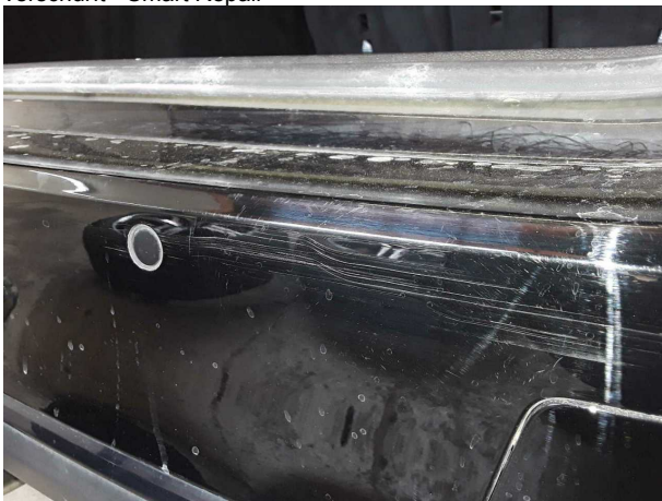
Beschädigung #4: Stossfänger hinten: Stossfänger hinten - verkratzt / verschürft - instandsetzen und lackieren
