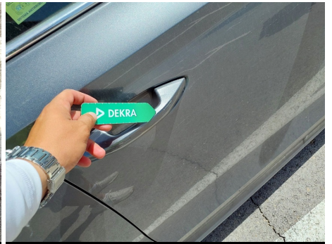
Manetas de puerta / Delantero Derecho / Ralladura
