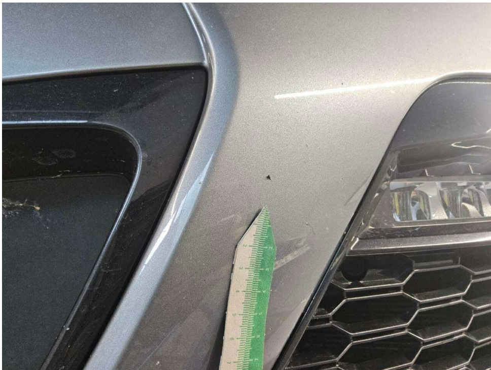
Bild 20 : Stoßfänger vorne Lackierung, Steinschlag, Gebrauchsspur
