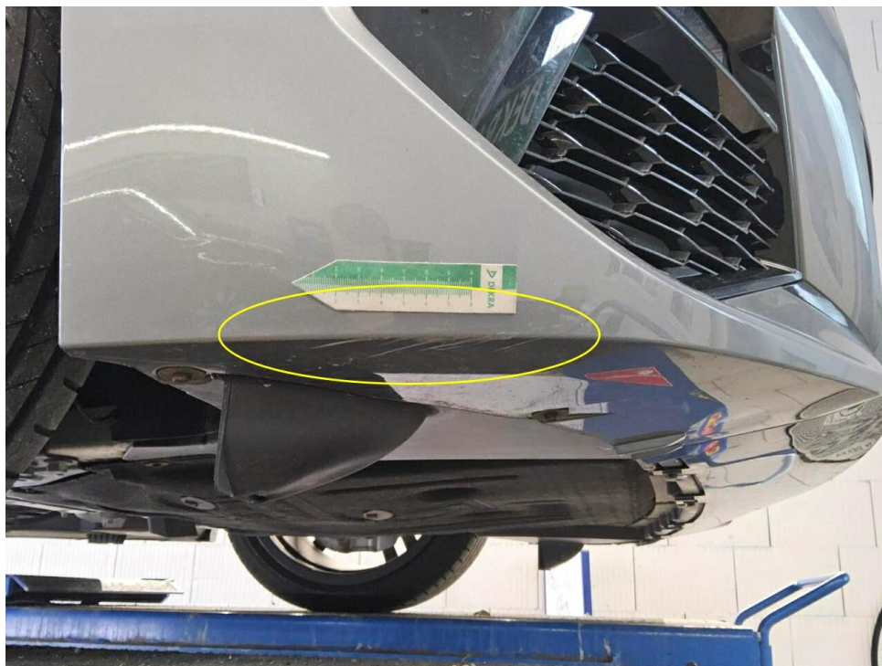
Bild 21 : Frontspoiler Lackierung, verschrammt, lackieren mit Lackaufbau
