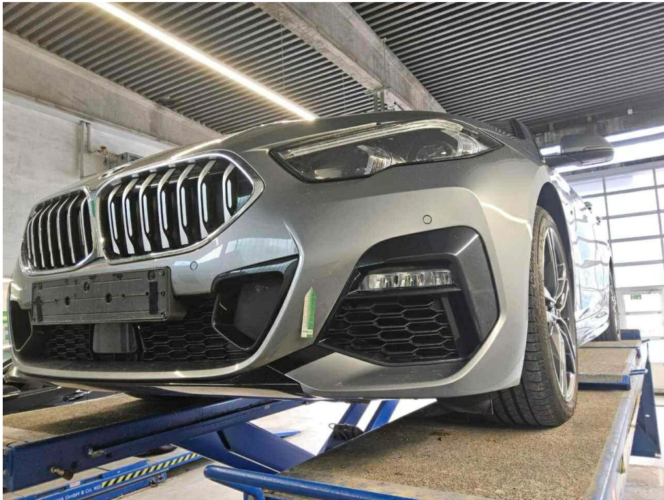
Bild 19 : Stoßfänger vorne Lackierung, Steinschlag, Gebrauchsspur
