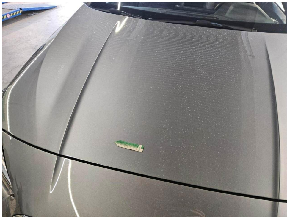
Bild 17 : Motorhaube Lackierung, Steinschlag, Gebrauchsspur
