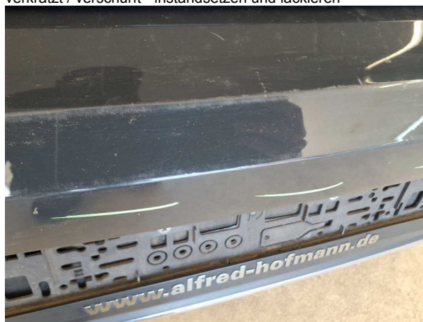
Beschädigung #4: Stossfänger hinten: Stossfänger hinten - verkratzt / verschürft - instandsetzen und lackieren
