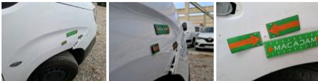
Door trim RR, Scratch(es), Replace
