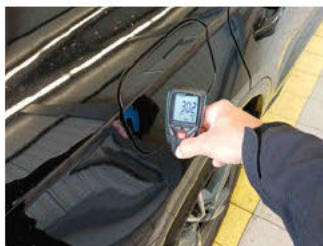
Lackstärke Seitenwand hinten rechts
