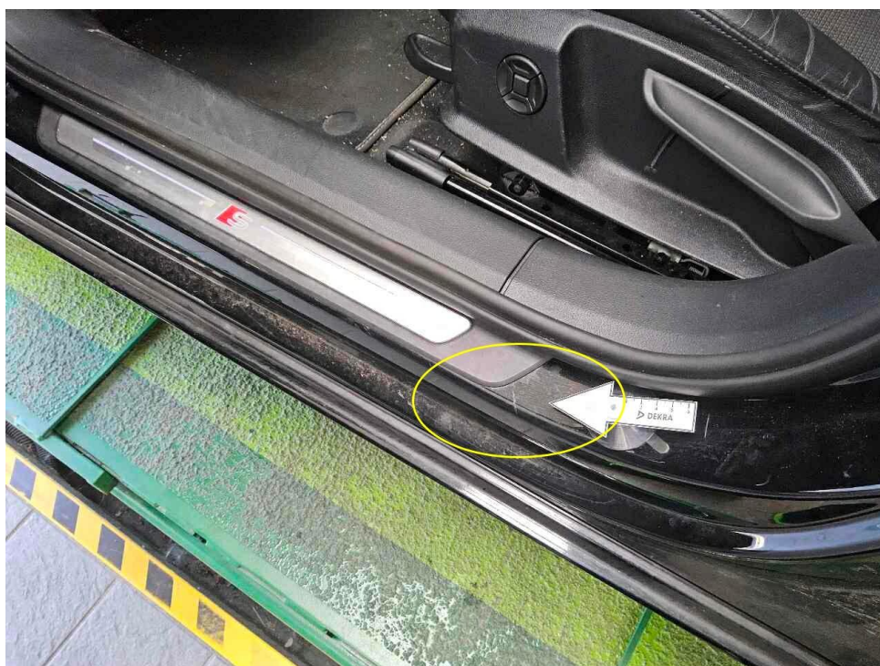
Bild 56 : Einstieg vorne links, verschrammt
