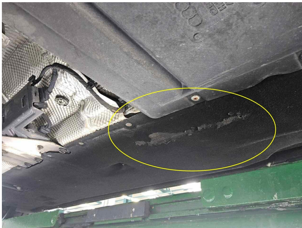
Bild 47 : Unterfahrschutz mittig, zerkratzt
