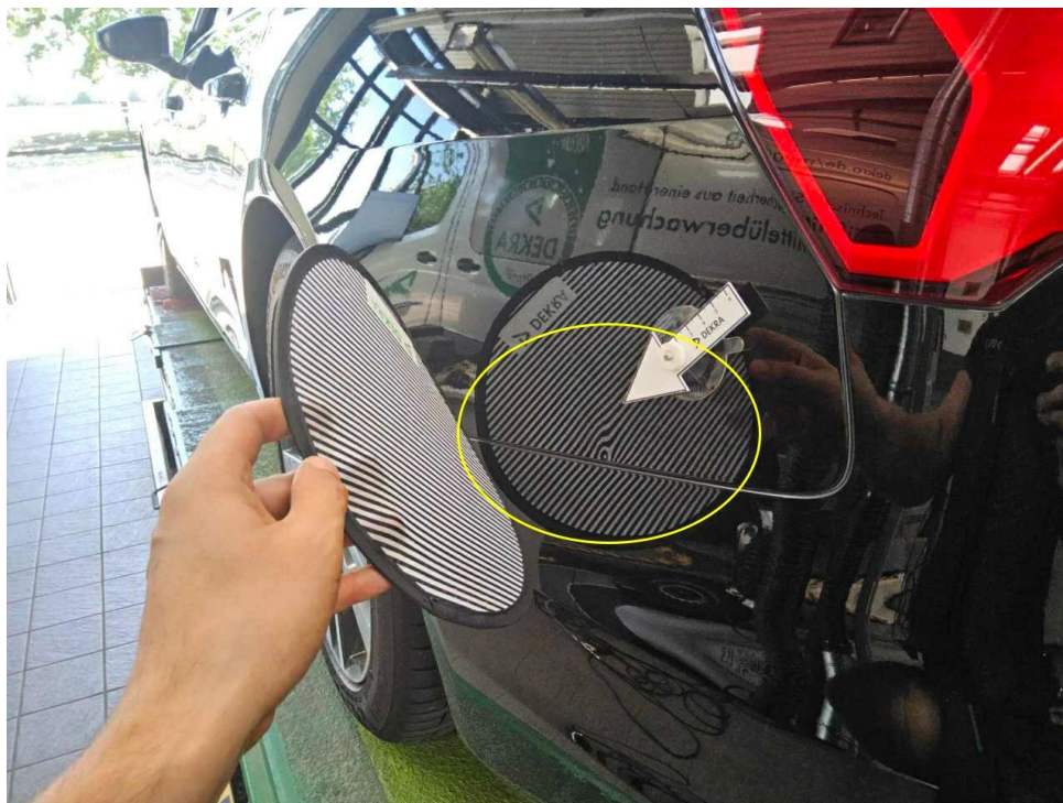
Bild 17 : Seitenteil hinten links, deformiert, instandsetzen und lackieren mit Lackaufbau
