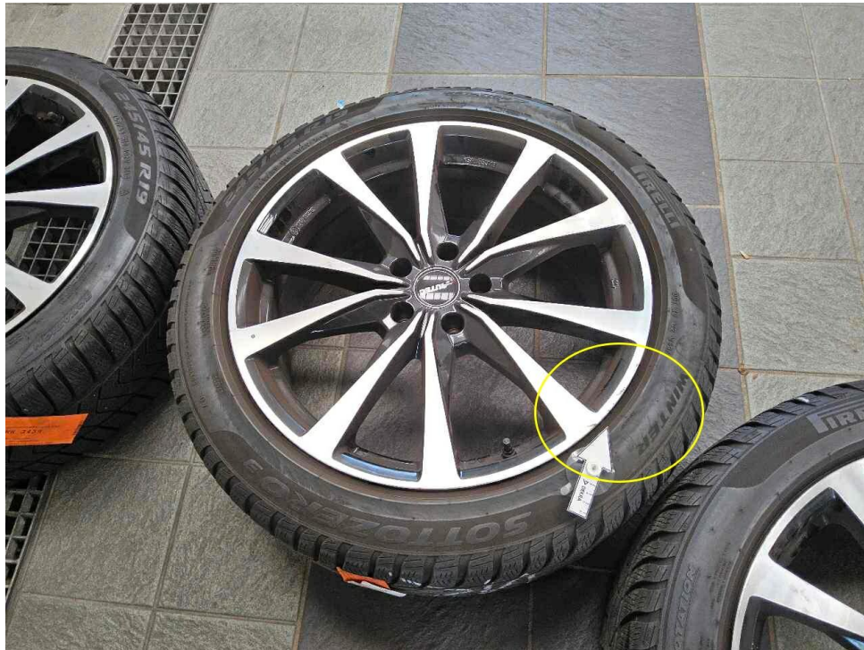
Bild 37 : Zubehörfelge vorne rechts (Winterradsatz), zerkratzt
