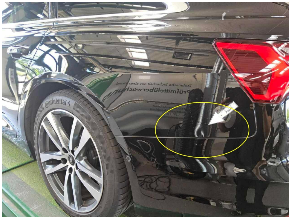
Bild 16 : Seitenteil hinten links, deformiert, instandsetzen und lackieren mit Lackaufbau
