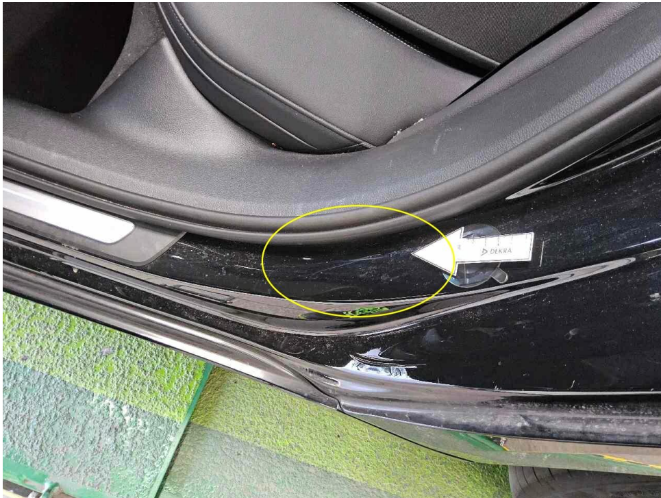
Bild 57 : Einstieg hinten links, verschrammt
