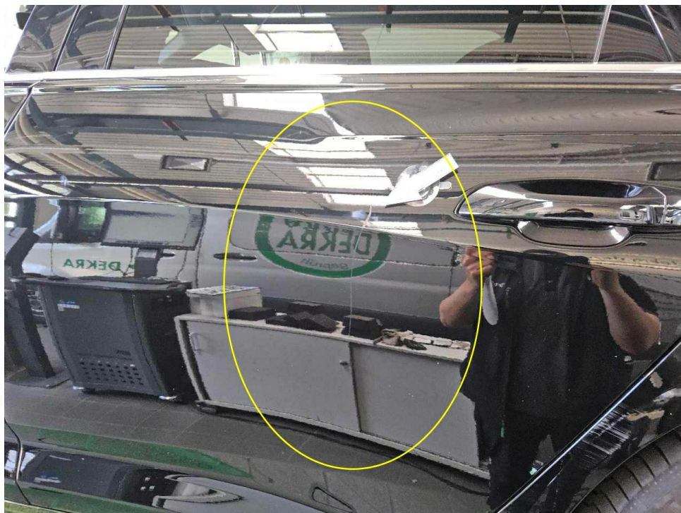
Bild 54 : Tür hinten links, verschrammt
