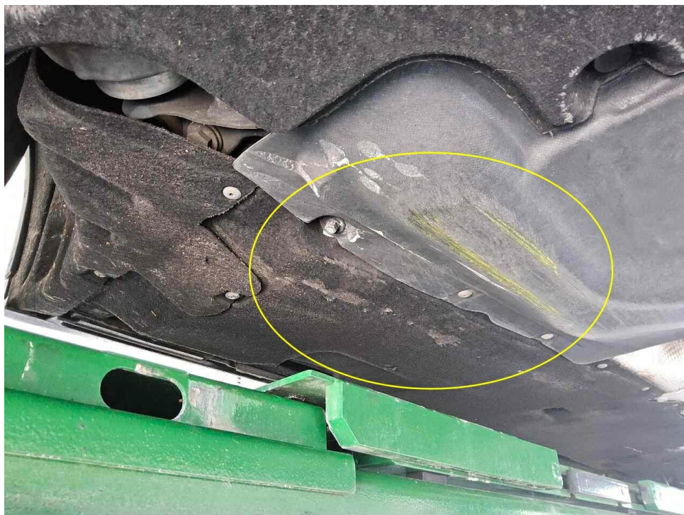
Bild 48 : Unterfahrschutz mittig, zerkratzt
