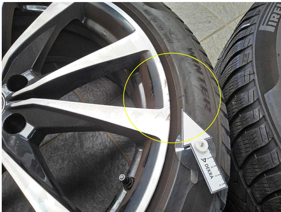
Bild 36 : Zubehörfelge vorne rechts (Winterradsatz), zerkratzt
