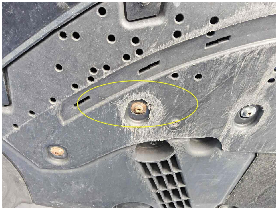
Bild 49 : Unterfahrschutz vorne, gebrochen
