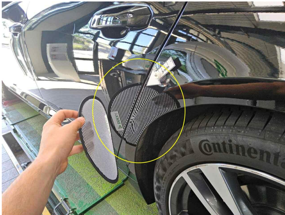
Bild 19 : Seitenteil hinten links, deformiert, instandsetzen und lackieren mit Lackaufbau
