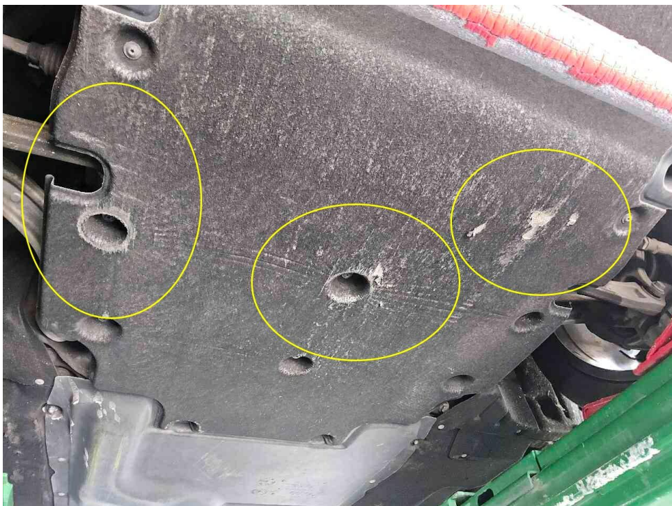
Bild 46 : Unterfahrschutz mittig, zerkratzt
