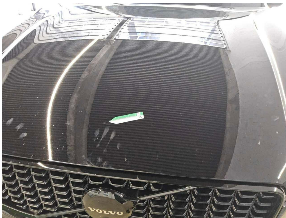
Bild 18 : Motorhaube Lackierung, Steinschlag, Gebrauchsspur
