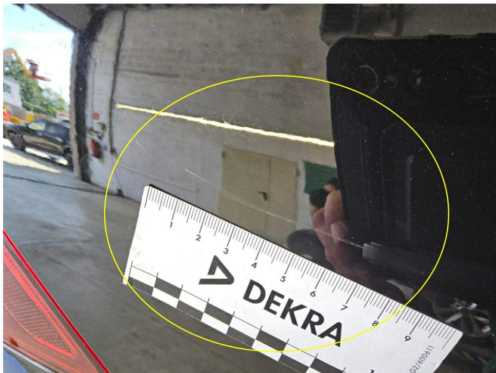
Bild 21 : Seitenteil hinten rechts Lackierung, verschrammt, lackieren mit Lackaufbau
