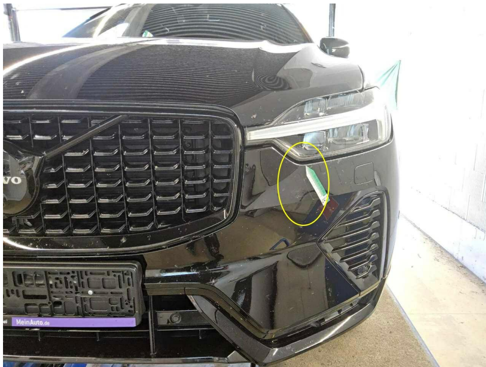
Bild 14 : Stoßfänger vorne Lackierung, verschrammt, lackieren mit Lackaufbau
