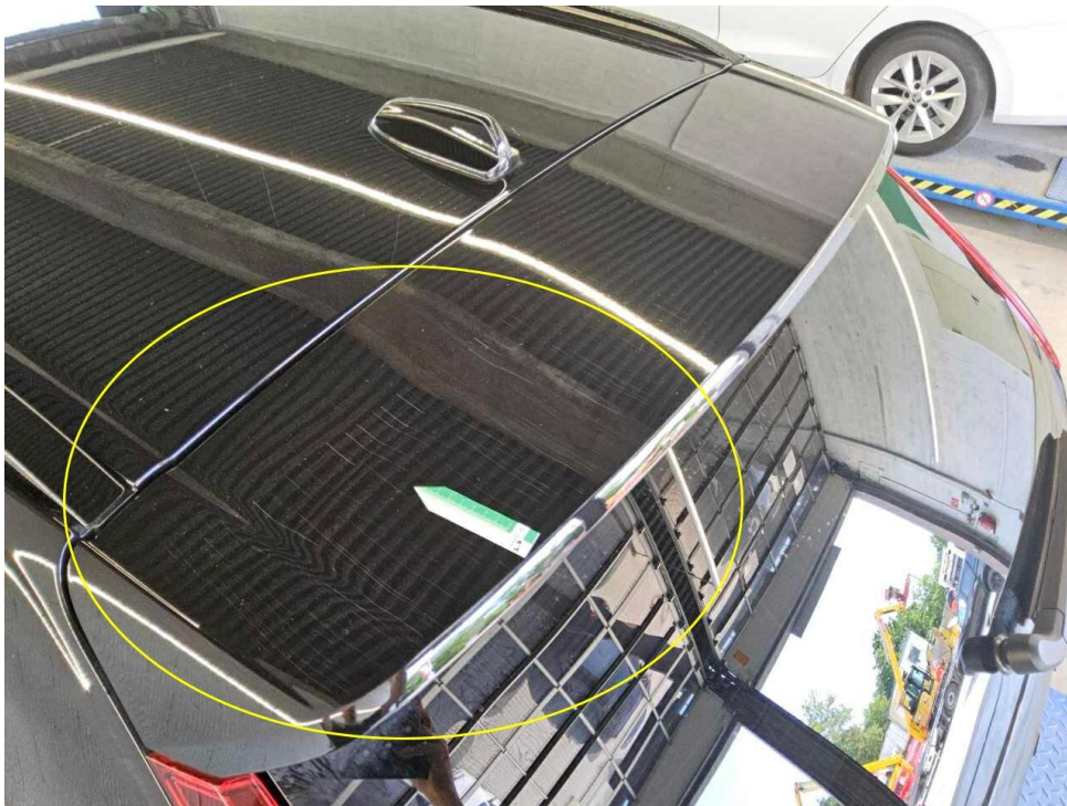
Bild 16 : Heckspoiler Lackierung, verschrammt, lackieren mit Lackaufbau
