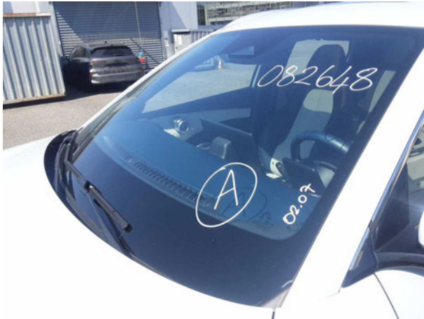
Beschädigung #4: Verglasung: Frontscheibe (Rissbildung) - Steinschlag - erneuern
