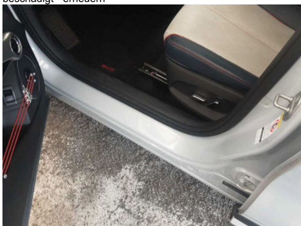
Beschädigung #2: Schweller links: Einstieg - Delle(n) - sanft instandsetzen
