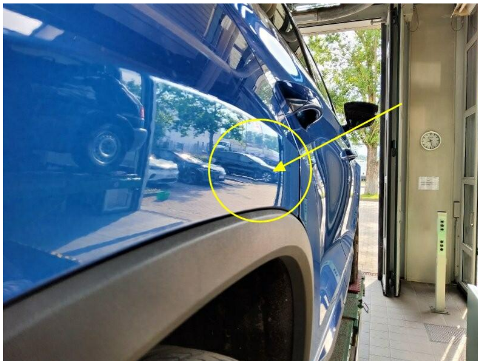
Bild 13 : Seitenwand rechts Delle am Radlauf
