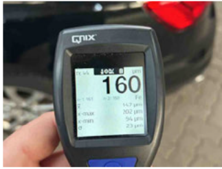
Lackstärke Seitenwand hinten links
