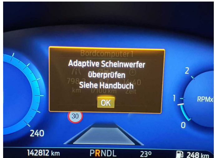
Damage 3: Instrument panel: Indicator light (Adaptive Scheinwerfer überprüfen) - on - Perform diagnosis
