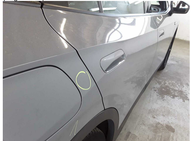
Beschädigung #4: Seitenwand rechts: Seitenwand - Delle(n) - sanft instandsetzen
