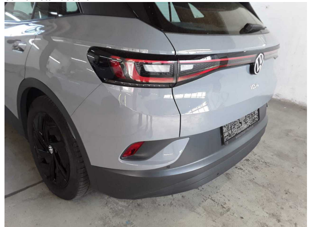
Beschädigung #5: Stossfänger hinten: Stossfänger hinten - verkratzt / verschürft - Smart Repair
