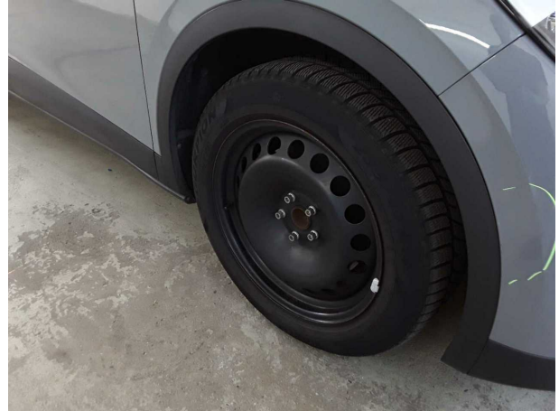
Beschädigung #2: Rad/Reifen: Radblende vorn rechts (Original fehlt) - erneuern
