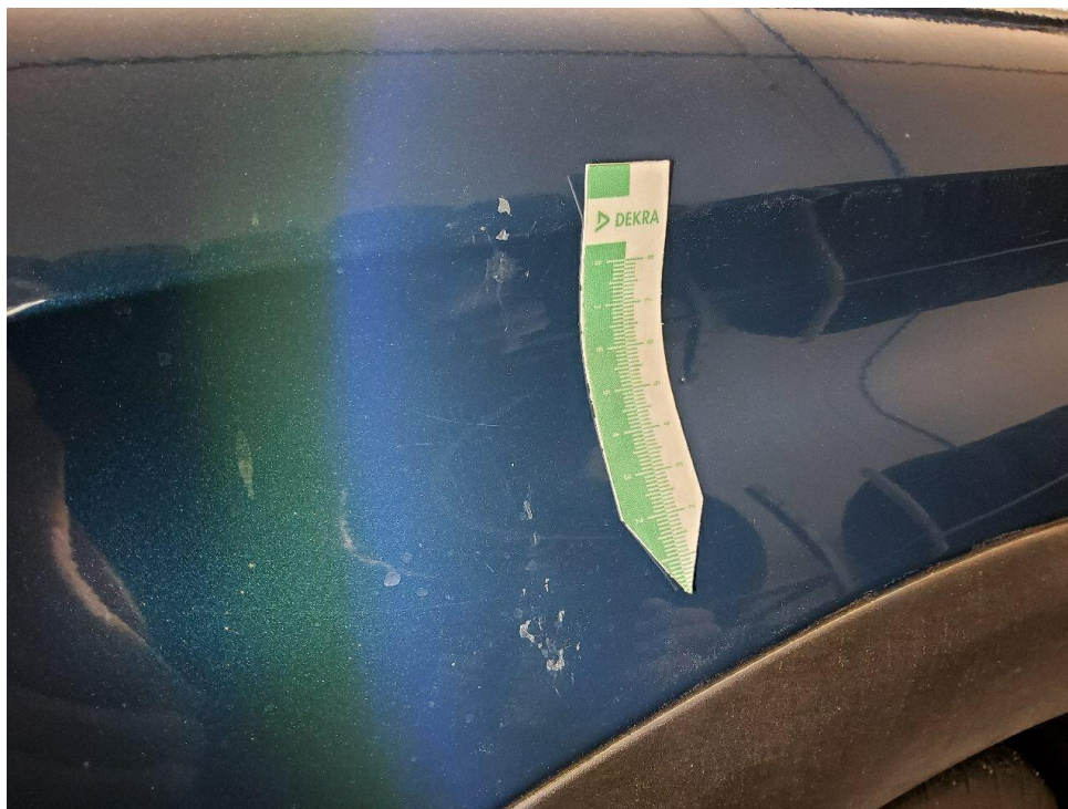
Bild 20 : Kotflügel vorn links Lackierung Umweltschaden Anhaftung reinigen und polieren
