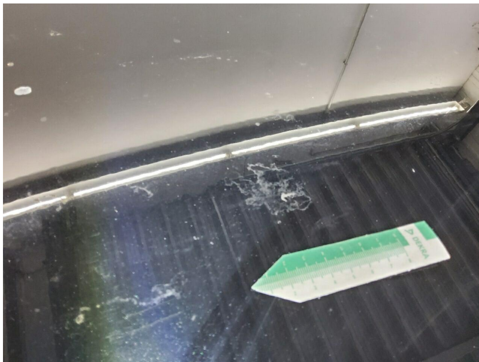
Bild 18 : Dach Lackierung Umweltschaden Anhaftungen reinigen und polieren
