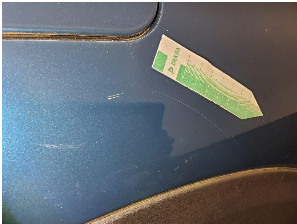
Bild 22 : Seitenwand hinten rechts zerkratzt
