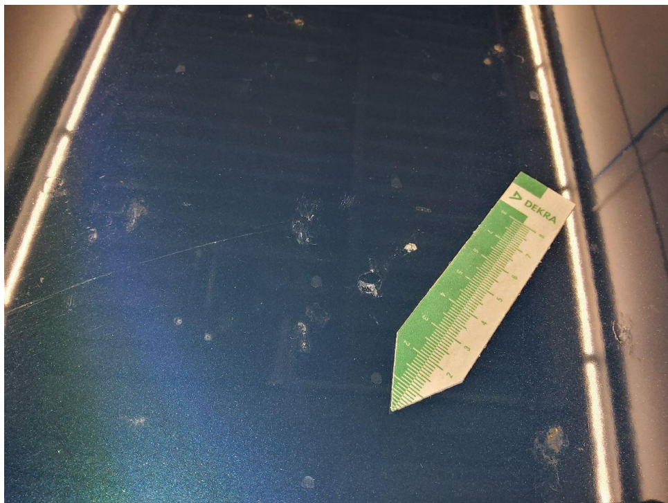
Bild 16 : Motorhaube Lackierung Umweltschaden Anhaftungen reinigen und polieren
