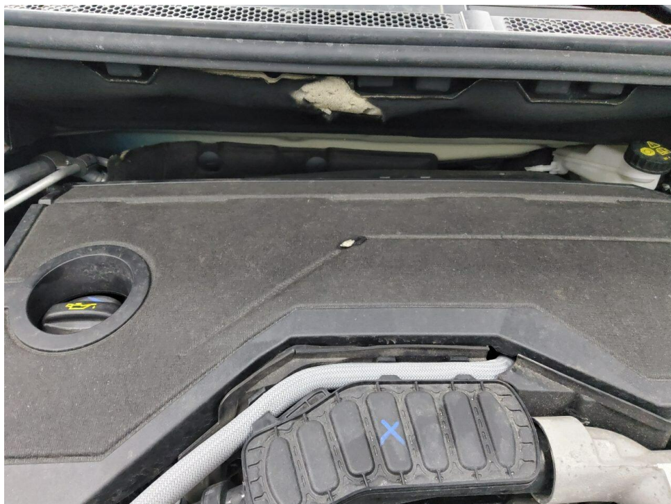
Bild 14 : Dämmmatte Motorraum Spritzwand oben beschädigt
