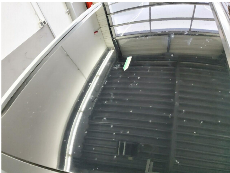
Bild 17 : Dach Lackierung Umweltschaden Anhaftungen reinigen und polieren
