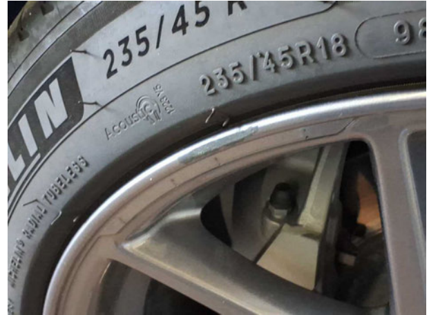
Beschädigung #1: Rad/Reifen: Leichtmetallfelge vorn rechts - beschädigt - erneuern
