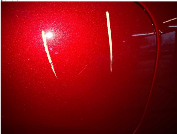
Beschädigung #2: Kraftstoffanlage: Tankdeckel - Kratzer - Smart Repair
