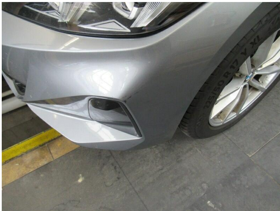
Bild 15 : - Stoßfänger vl verschrammt
