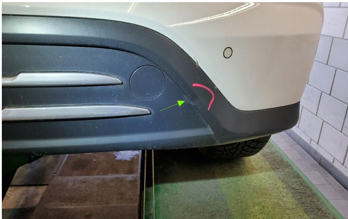
Bild 13 : Verkleidung Stoßfänger hinten angefahren
