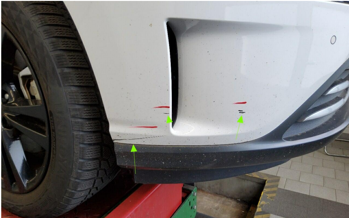
Bild 17 : Stoßfänger vorne verschrammt
