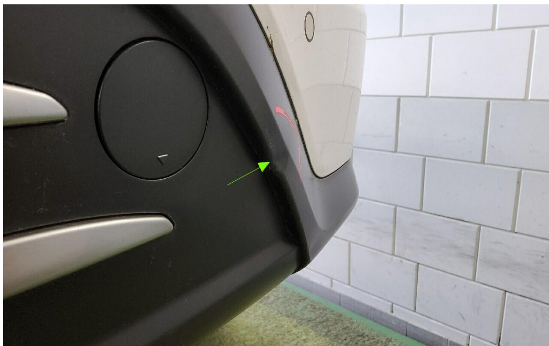
Bild 14 : Verkleidung Stoßfänger hinten angefahren
