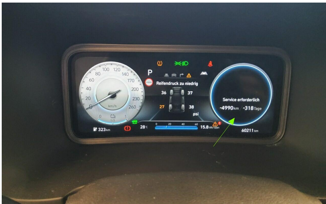
Bild 8 : Service laut Anzeige überfällig
