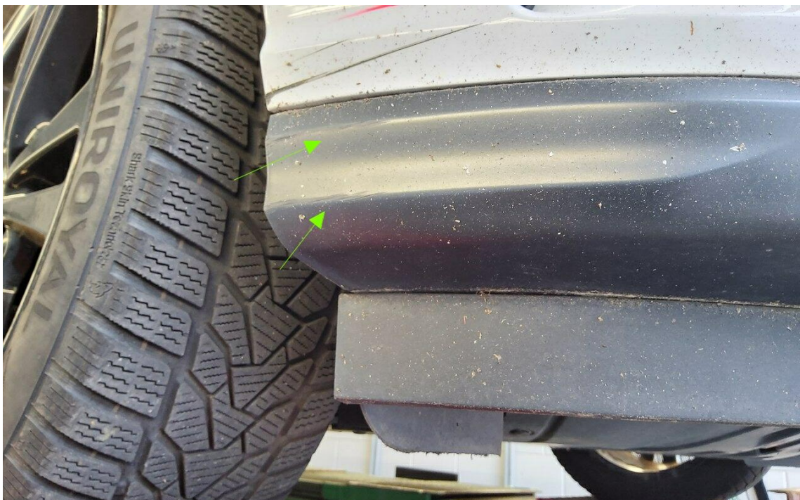
Bild 18 : Verkleidung Stoßfänger vorne verschrammt
