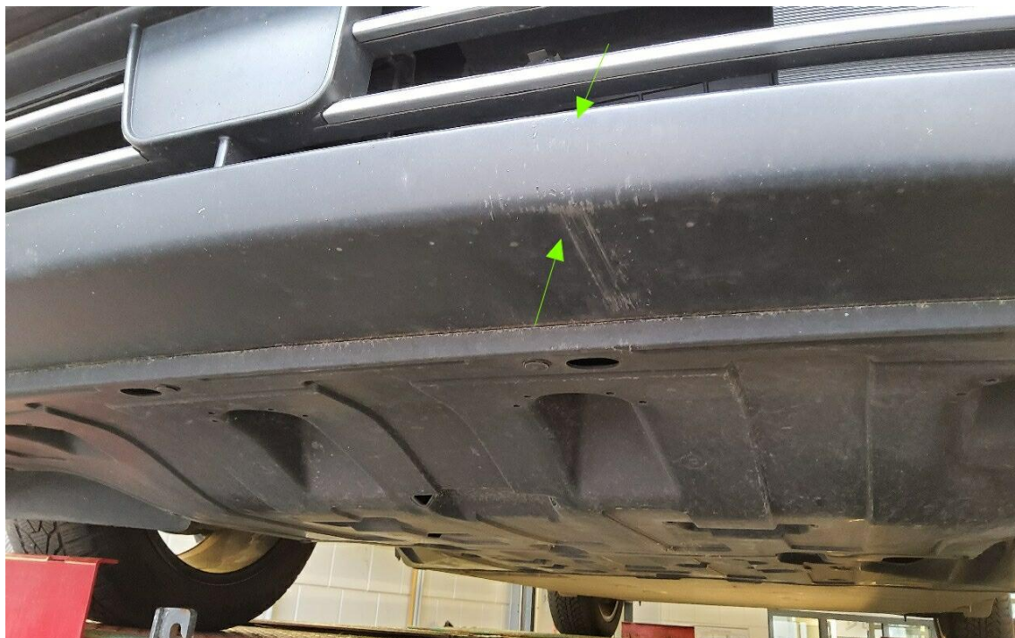
Bild 19 : Verkleidung Stoßfänger vorne verschrammt
