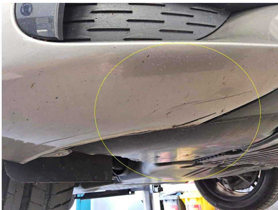
Bild 18 : Stoßfänger vorne mehrfach verschrammt
