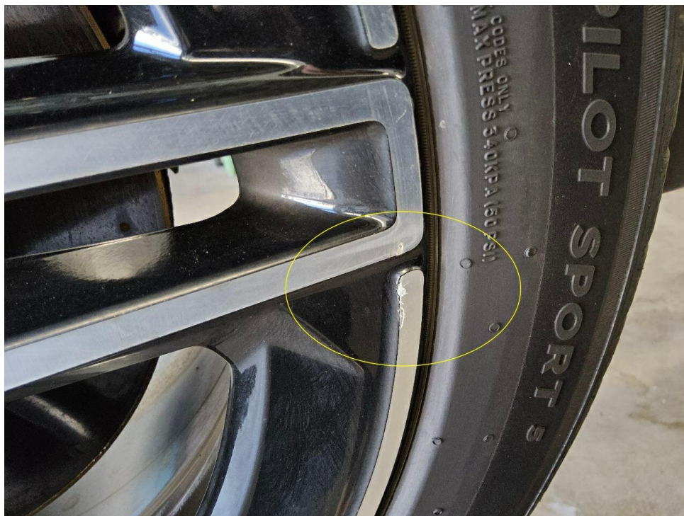
Bild 13 : Felge hinten rechts verschrammt
