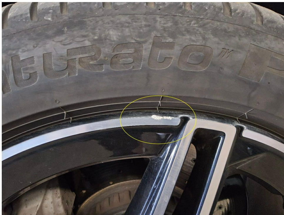
Bild 12 : Felge vorne rechts verschrammt
