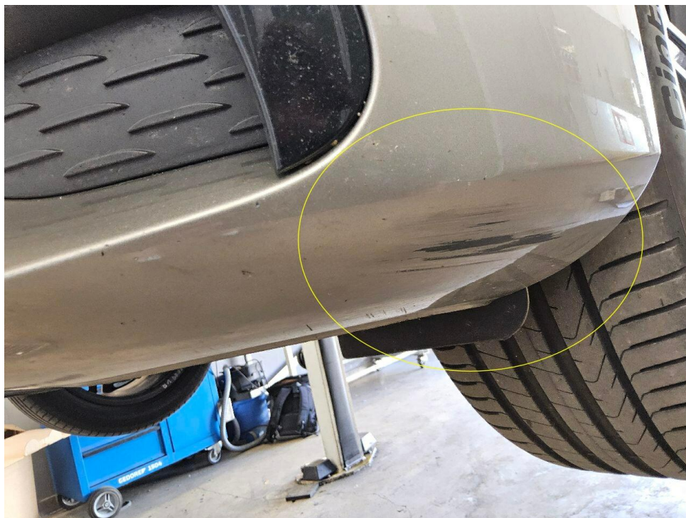
Bild 19 : Stoßfänger vorne mehrfach verschrammt
