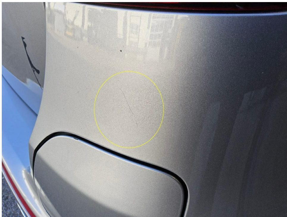
Bild 10 : Stoßfänger hinten Kratzer
