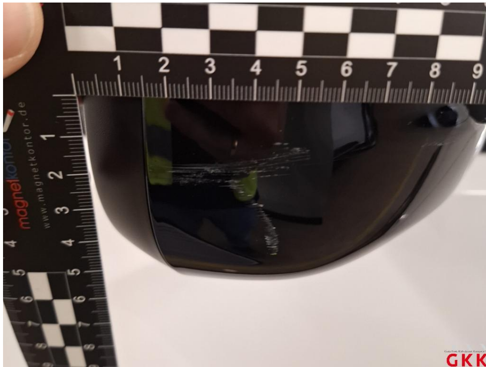
Bild 15 Spiegelgehäuse rechts, Kappe -lackiert-, verkratzt, lackieren ohne LV
