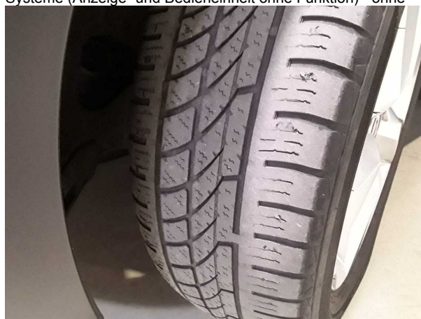
Beschädigung #7: Rad/Reifen: Reifen vorn (2 x Ganzjahresreifen vorne unter 4 mm Profiltiefe) - entspricht nic...
