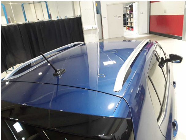
Beschädigung #4: Fahrzeugdach: Dach - Delle(n) - sanft instandsetzen
