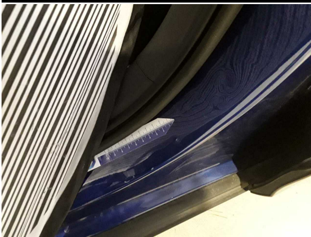
Beschädigung #13: Karosserie: B-Säule links unten (inklusive Türeinstieg hinten, SW hinten) - Delle / Lackschaden -
