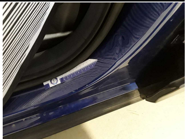
Beschädigung #13: Karosserie: B-Säule links unten (inklusive Türeinstieg hinten, SW hinten) - Delle / Lackschaden -
