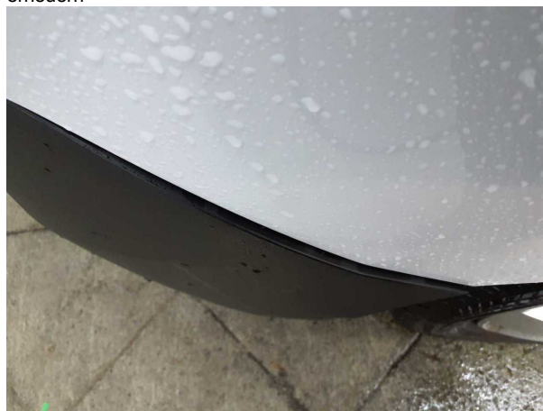
Beschädigung #2: Stossfänger vorn: Stossfänger vorn - verformt - erneuern
