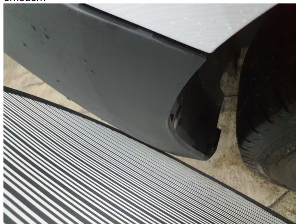
Beschädigung #2: Stossfänger vorn: Stossfänger vorn - verformt - erneuern
