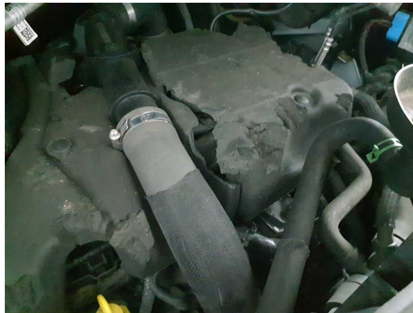
Beschädigung #1: Motor: Motorabdeckung - Marderschaden - erneuern
