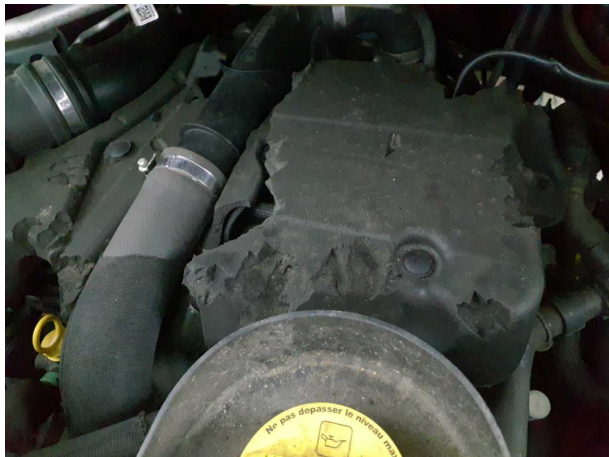
Beschädigung #1: Motor: Motorabdeckung - Marderschaden - erneuern
