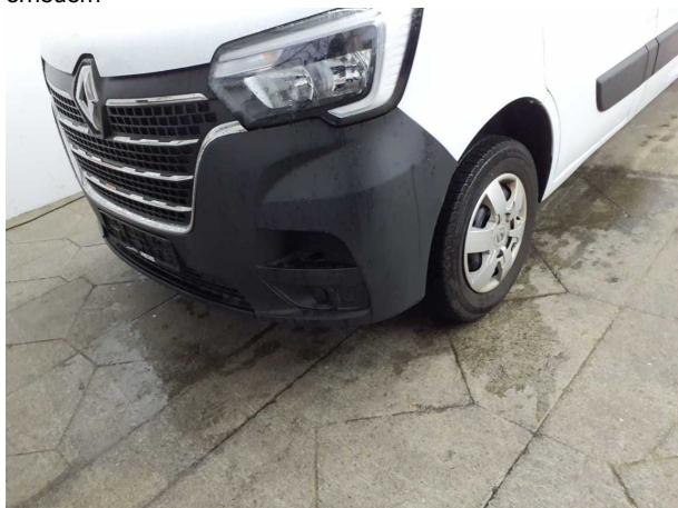
Beschädigung #2: Stossfänger vorn: Stossfänger vorn - verformt - erneuern
