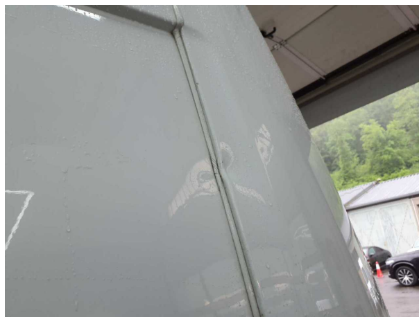
Beschädigung #5: Seitenwand links: Seitenwand (inkl. D-Säule) - Delle / Lackschaden - instandsetzen und lackieren
