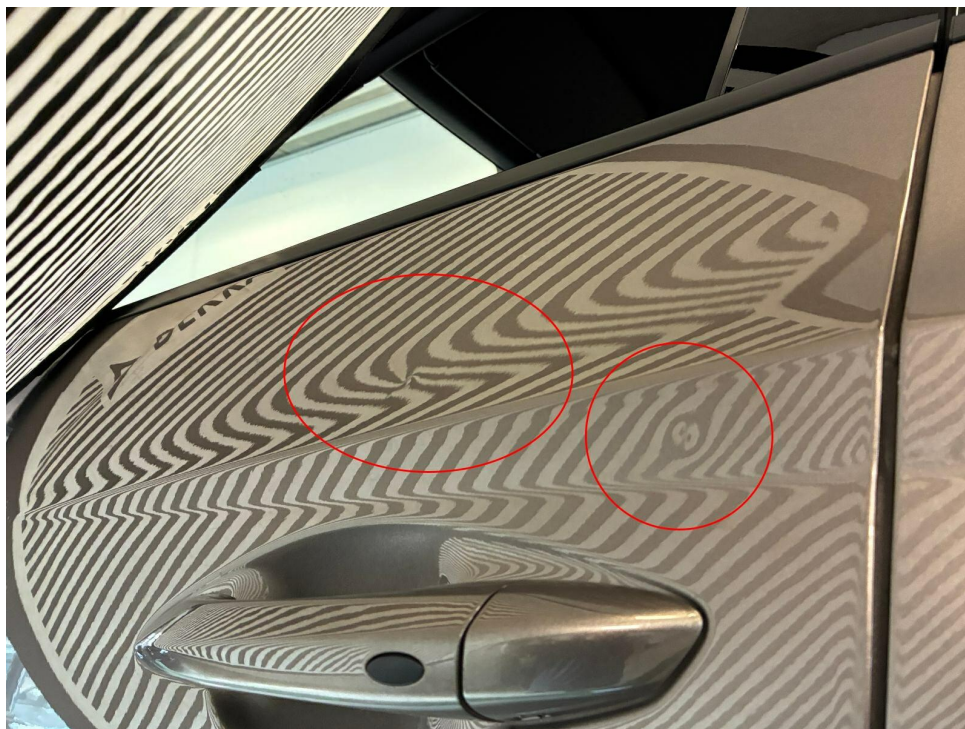
Bild 20 : Türe vorne links Kratzer + Dellen
