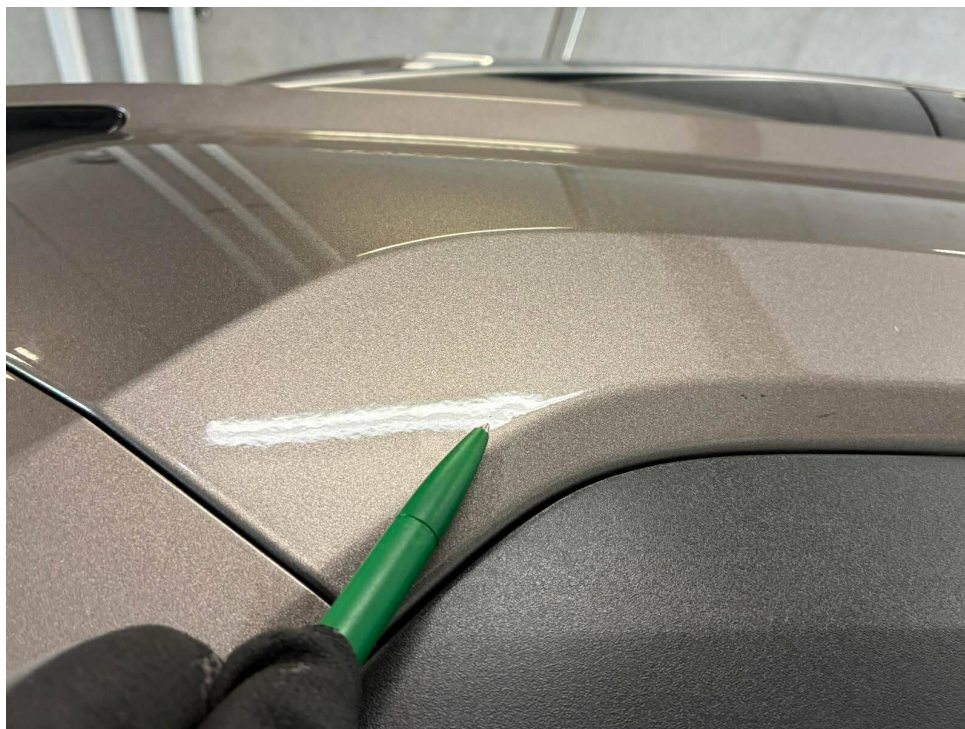
Bild 16 : Seitenwand hinten rechts Kratzer + Dellen
