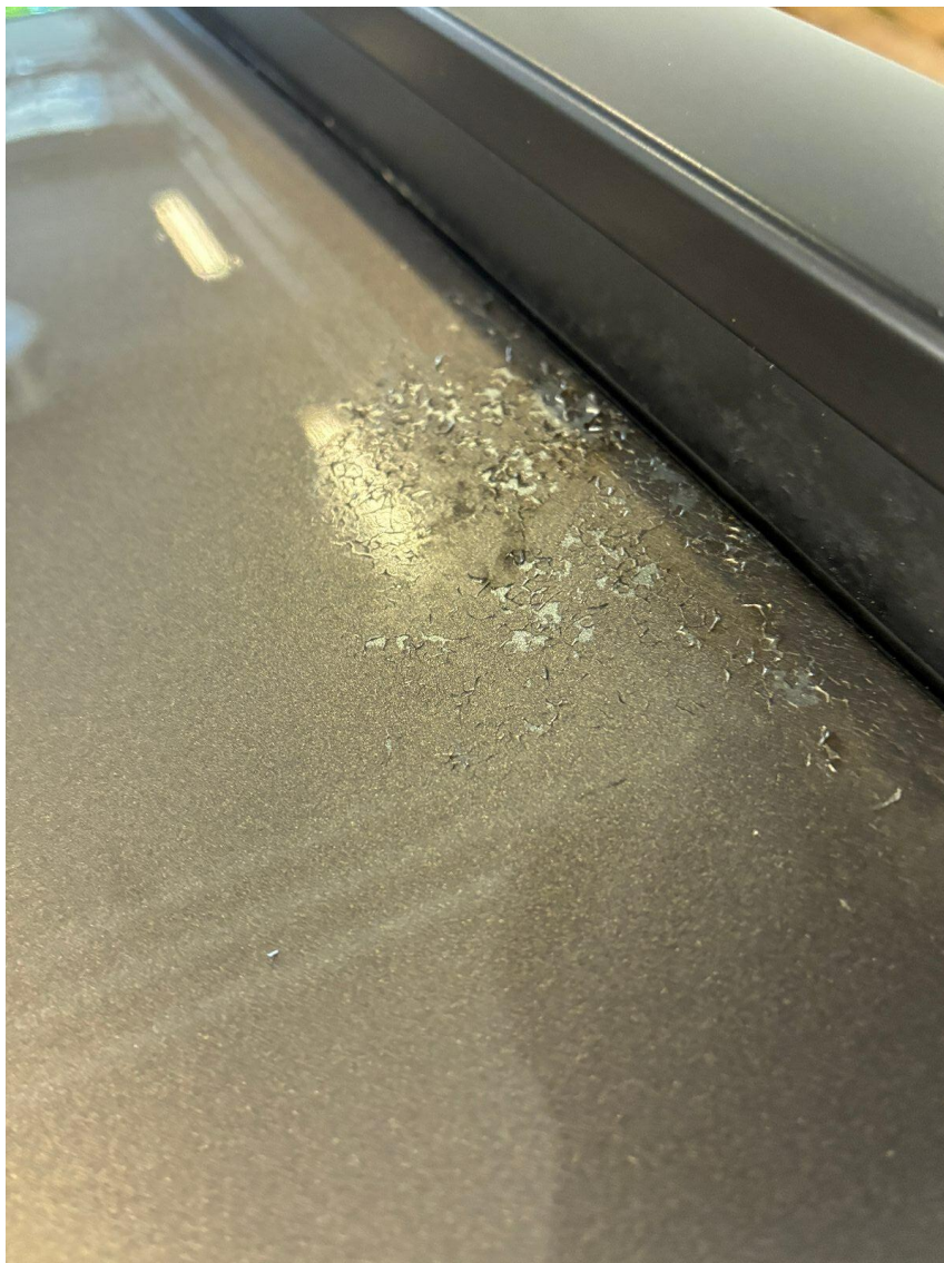
Bild 11 : Fahrzeugdach Lackeinätzung mit Oberflächenschaden
