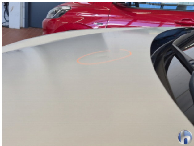
2. Motorhaube 1 Delle - Sanft Instandsetzen
