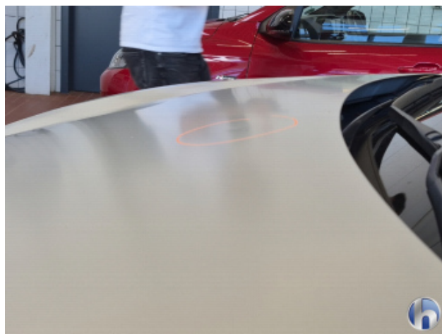
2. Motorhaube 1 Delle - Sanft Instandsetzen
