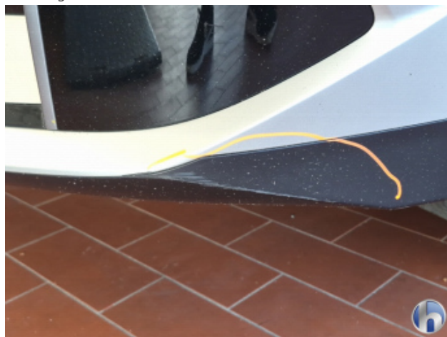
1. Stoßfänger Vorne Abschürfung - Smart Repair
