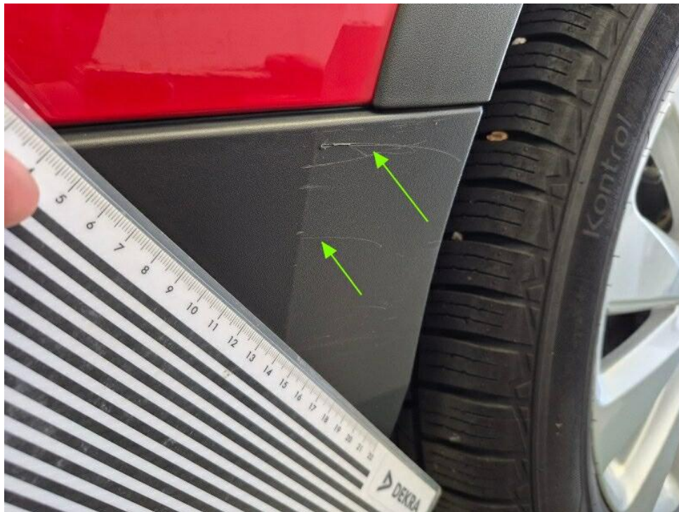
Bild 19 : Stoßfänger hinten Unterteil mehrfach verschrammt
