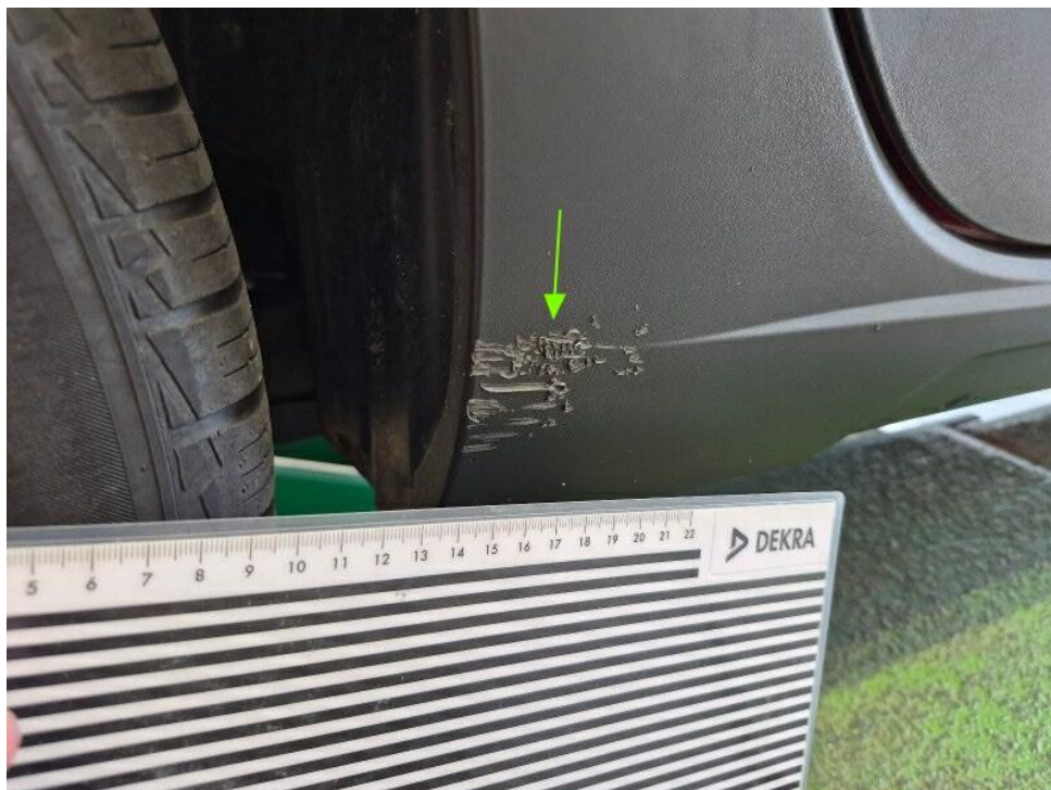
Bild 20 : Schwellerverkleidung rechts mehrfach mit Materialabtrag verschrammt
