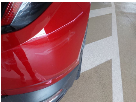
Stoßfänger / Hinten Rechts / Delle
