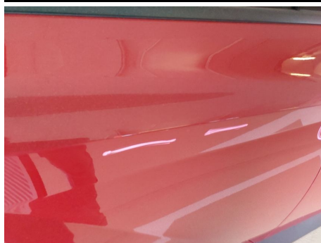
Tür / Hinten Rechts / Kratzer
