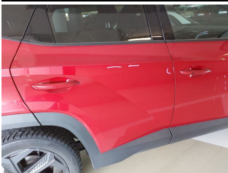
Tür / Hinten Rechts / Kratzer
