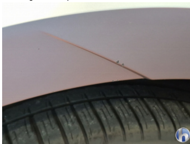
6. Seitenwand - Hinten - Rechts Abschürfung - Smart Repair
