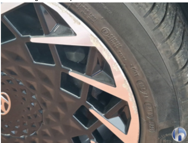
5. Felge Vorne - Rechts Beschädigt - Smart Repair
