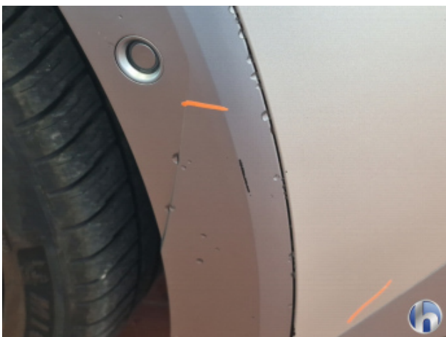
4. Kotflügel Vorne - Rechts Abschürfung - Smart Repair
