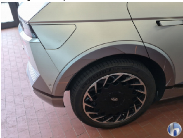
6. Seitenwand - Hinten - Rechts Abschürfung - Smart Repair
