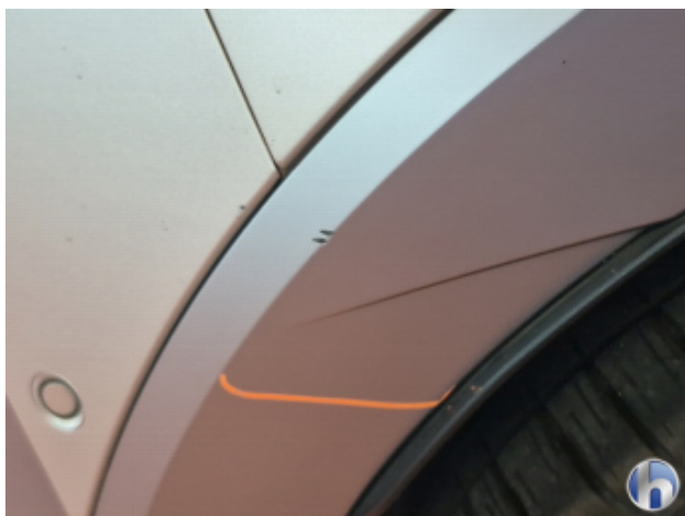
6. Seitenwand - Hinten - Rechts Abschürfung - Smart Repair
