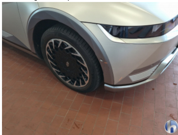
4. Kotflügel Vorne - Rechts Abschürfung - Smart Repair
