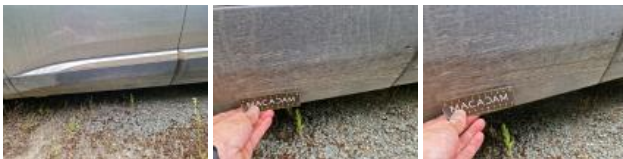
Door trim RL, Scratch(es), Replace
