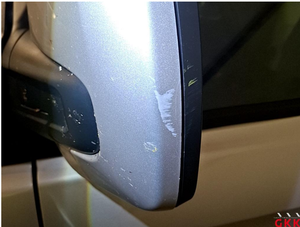
Bild 26 Spiegelgehäuse links, Kappe -lackiert-, verkratzt, lackieren
