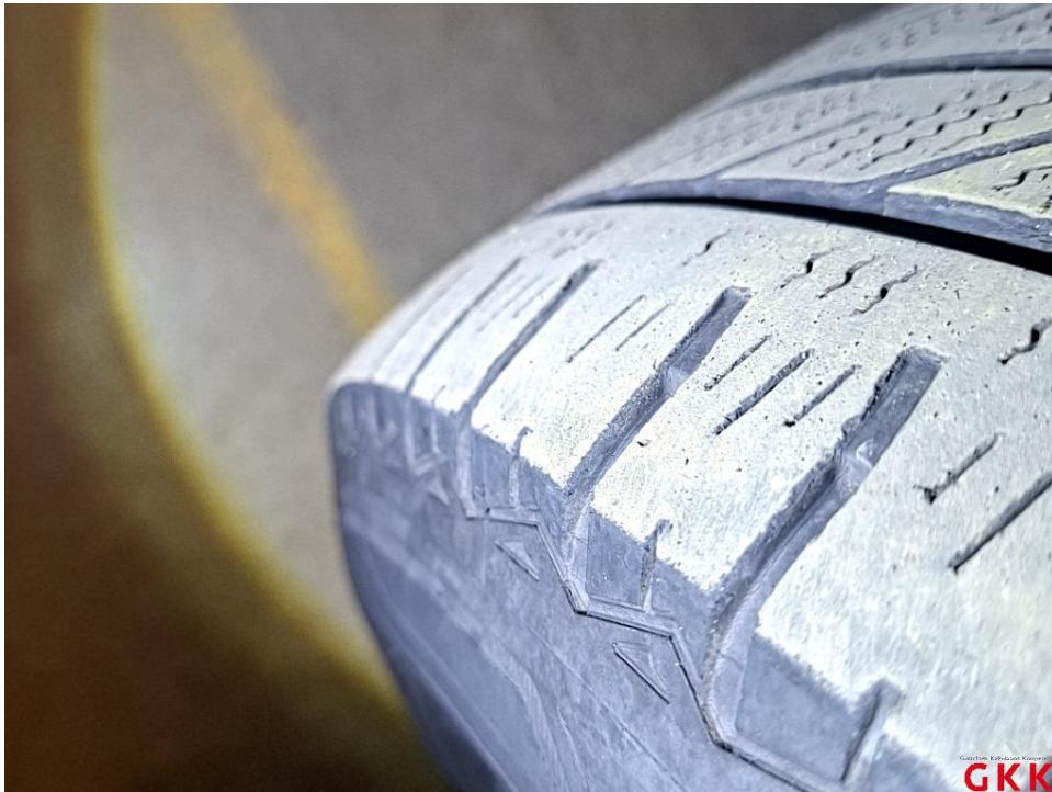
Bild 35 Reifen, vorne links, einseitig abgefahren, ersetzen
