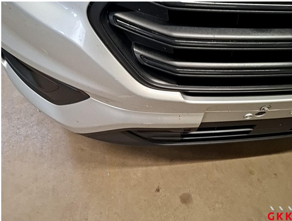
Bild 20 Stoßfänger vorne, Verkleidung oberhalb -lackiert-, verkratzt, lackieren
