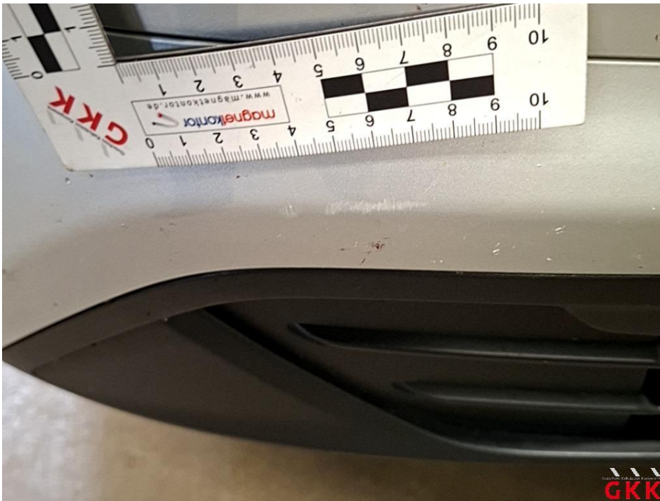
Bild 24 Stoßfänger vorne, Verkleidung unterhalb -lackiert-, verkratzt, lackieren
