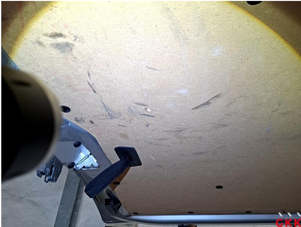
Bild 29 Heckklappe, Innenverkleidung, beschädigt, ersetzen
