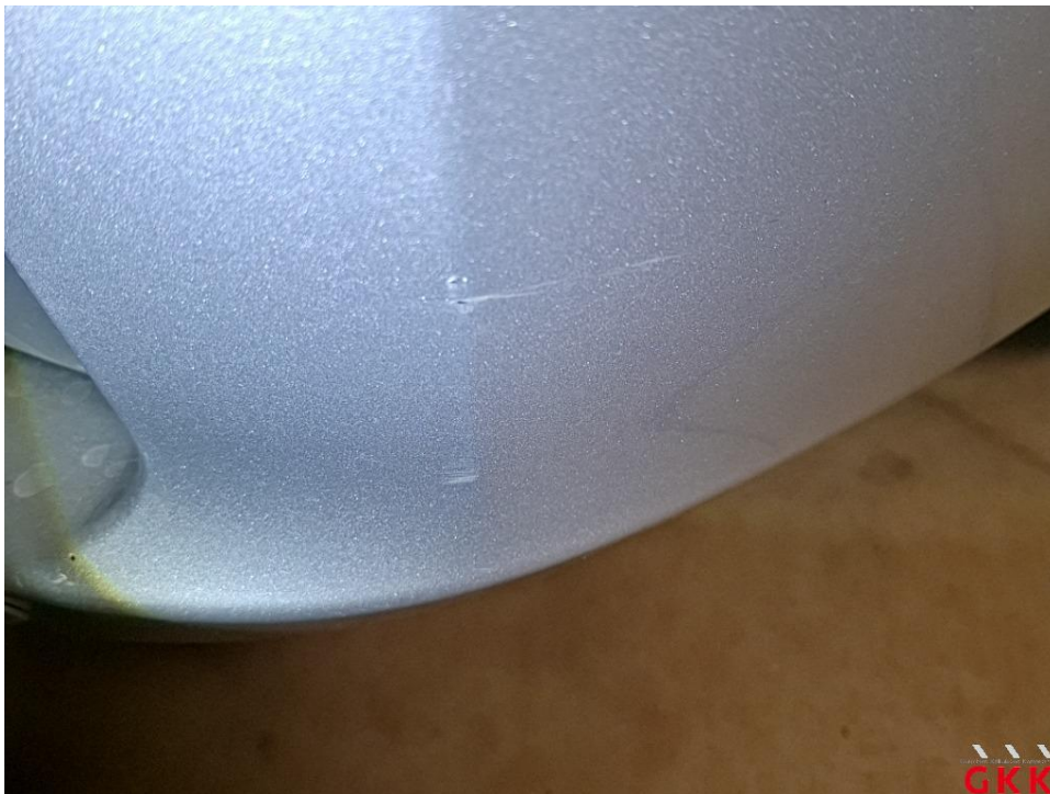
Bild 38 Stoßfänger hinten, Ecke rechts -lackiert-, verkratzt, lackieren
