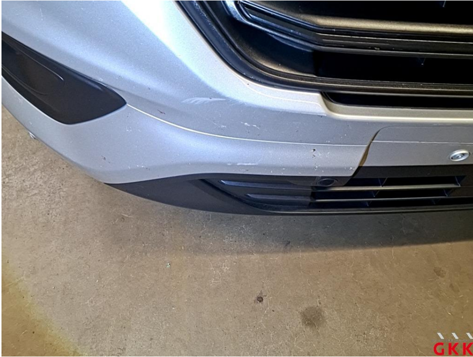
Bild 23 Stoßfänger vorne, Verkleidung unterhalb -lackiert-, verkratzt, lackieren
