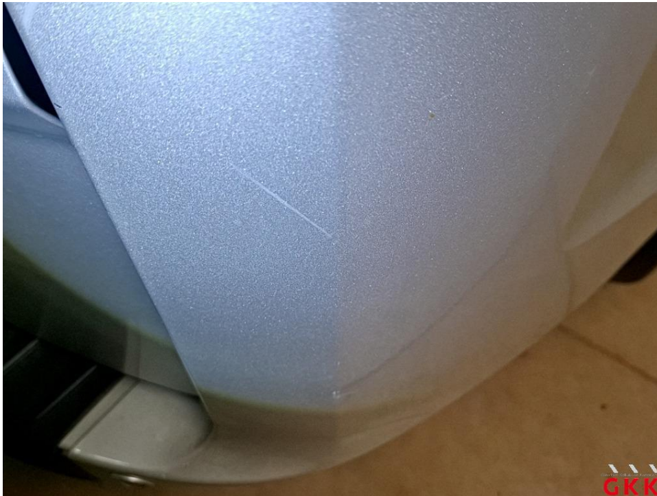
Bild 37 Stoßfänger hinten, Ecke rechts -lackiert-, verkratzt, lackieren
