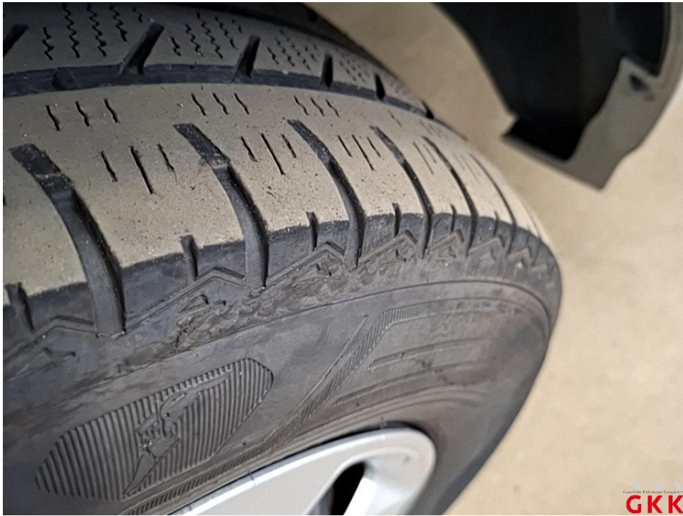
Bild 19 Reifen, vorne rechts, einseitig abgefahren und Untermaß, ersetzen
