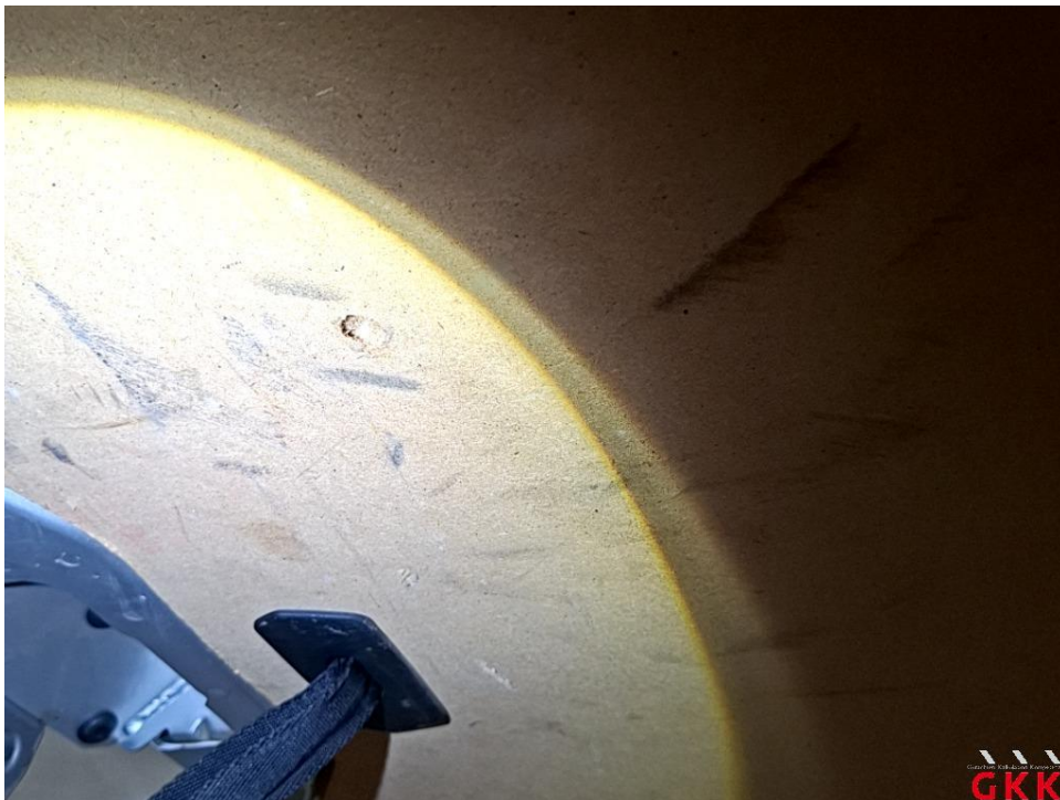
Bild 30 Heckklappe, Innenverkleidung, beschädigt, ersetzen
