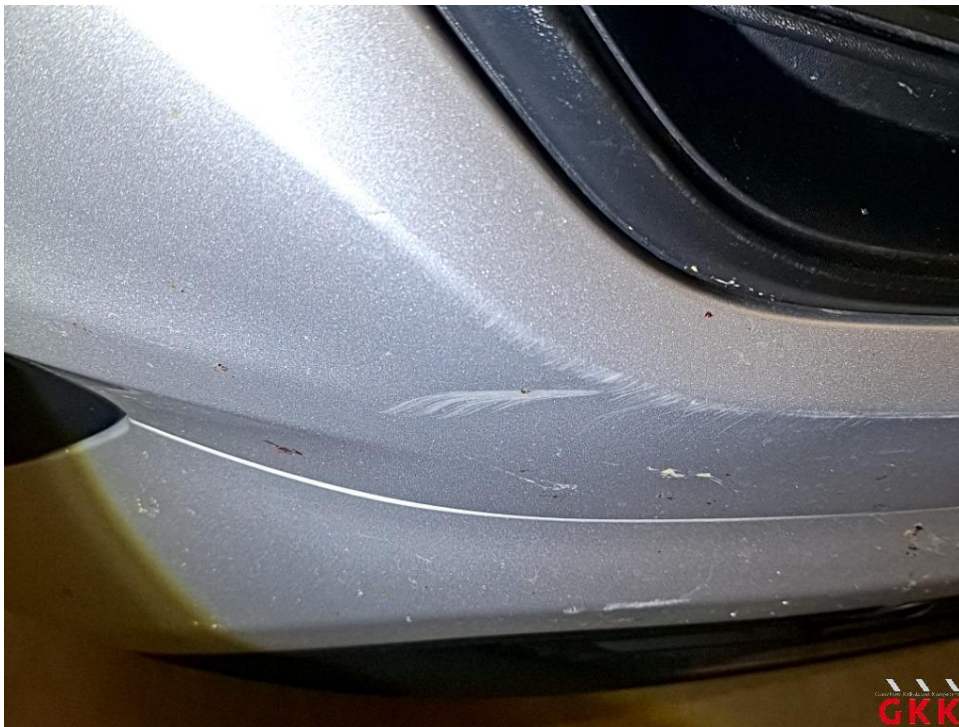
Bild 22 Stoßfänger vorne, Verkleidung oberhalb -lackiert-, verkratzt, lackieren
