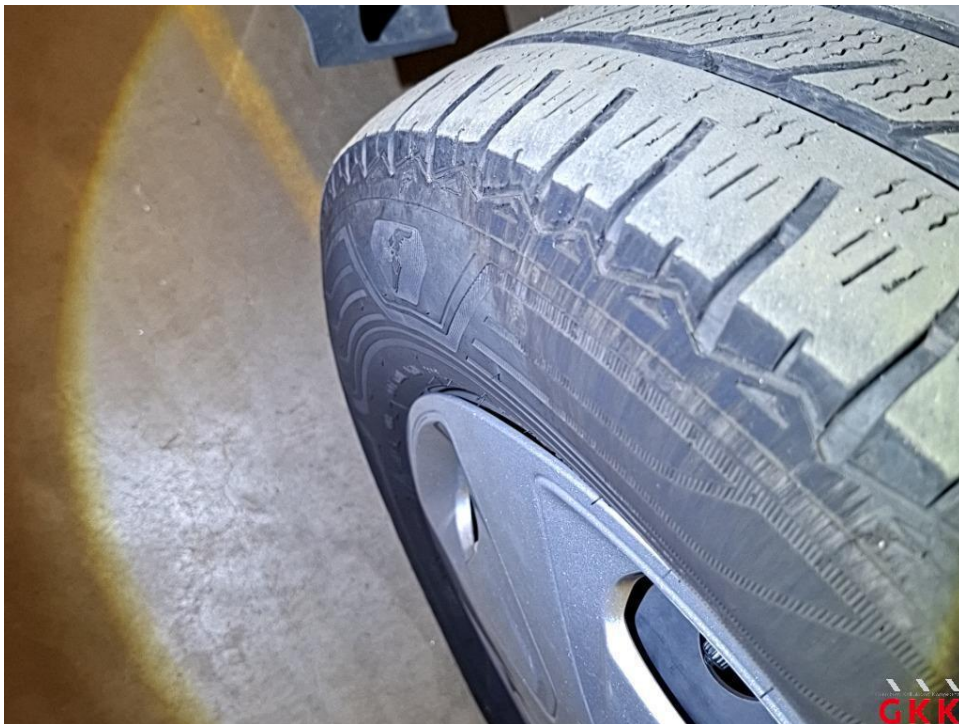
Bild 34 Reifen, vorne links, einseitig abgefahren, ersetzen
