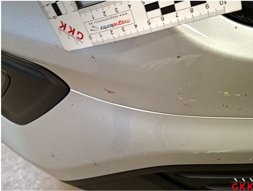
Bild 21 Stoßfänger vorne, Verkleidung oberhalb -lackiert-, verkratzt, lackieren
