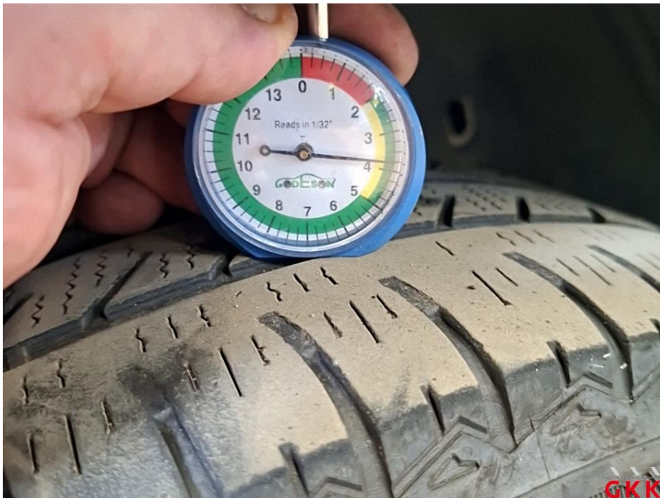
Bild 18 Reifen, vorne rechts, einseitig abgefahren und Untermaß, ersetzen
