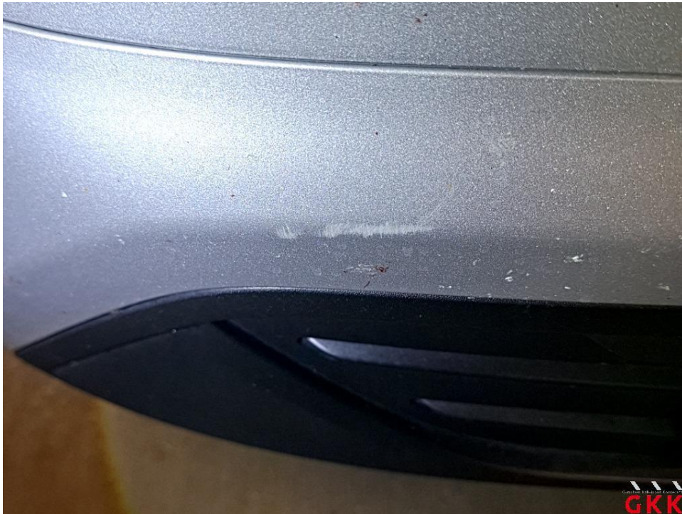
Bild 25 Stoßfänger vorne, Verkleidung unterhalb -lackiert-, verkratzt, lackieren
