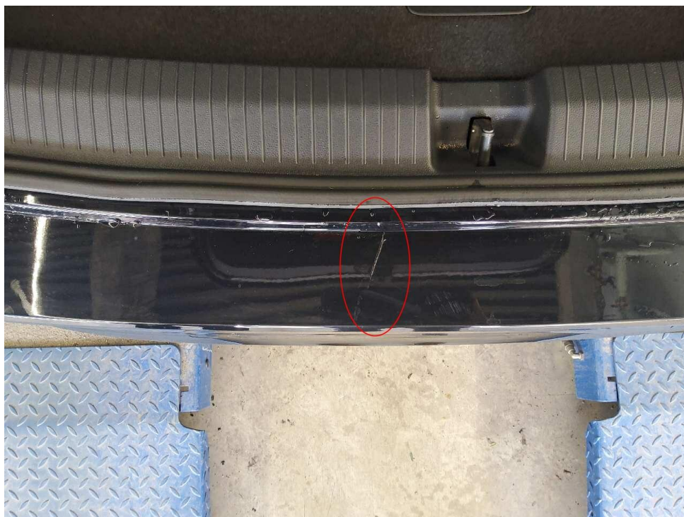
Bild 16 : Stoßfänger hinten, Lackierung zerkratzt
