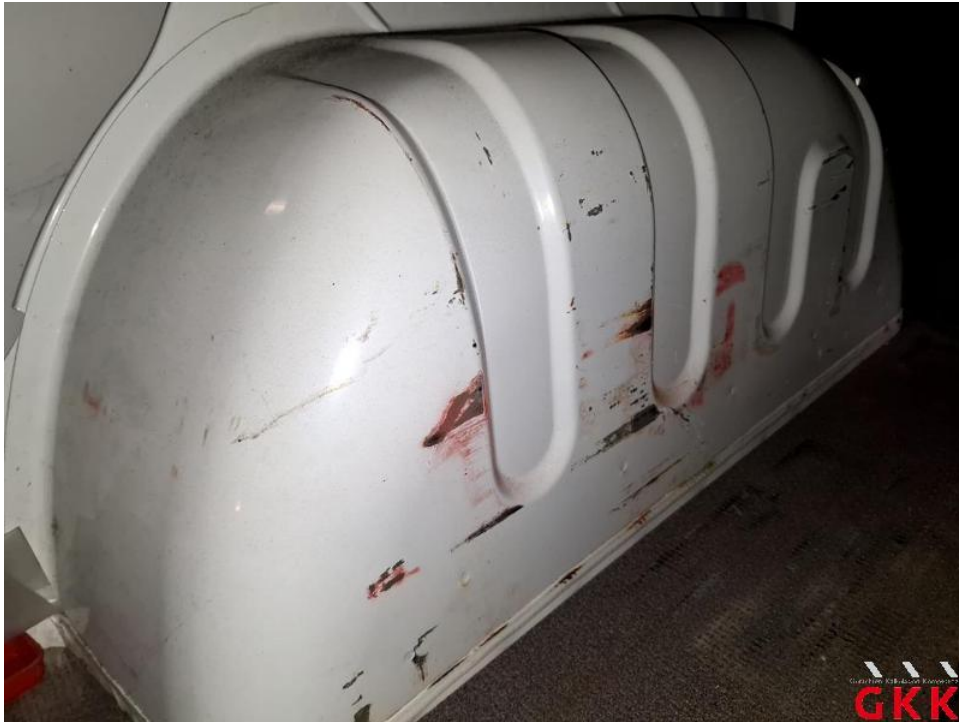
Bild 59. Radhaus hinten links, verkratzt, lackieren
