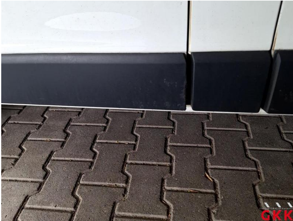
Bild 31. Tür vorne links, Leiste -unten-, beschädigt, ersetzen
