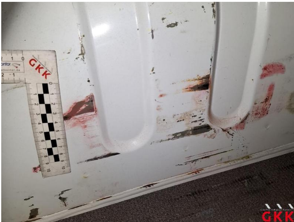
Bild 60. Radhaus hinten links, verkratzt, lackieren
