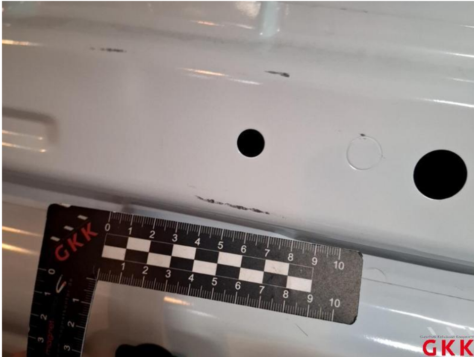
Bild 75. Trennwand, verkratzt, Smartrepair
