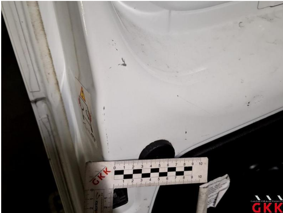
Bild 54. Hecktür links, innen, verkratzt, Smartrepair
