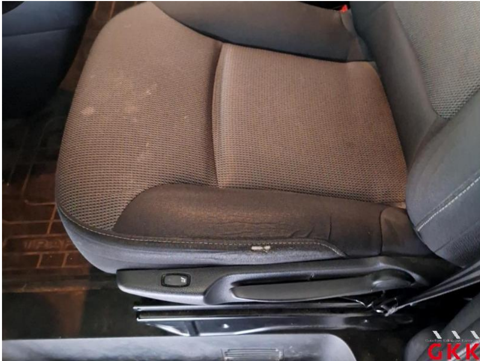
Bild 33. Sitz vorne links, Bezug Sitzkissen -Stoff-, beschädigt, ersetzen
