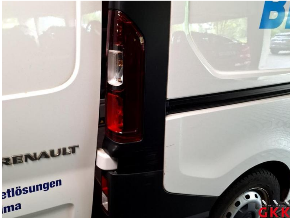
Bild 63. D- Säule rechts, Abdeckung -unlackiert-, beschädigt, ersetzen
