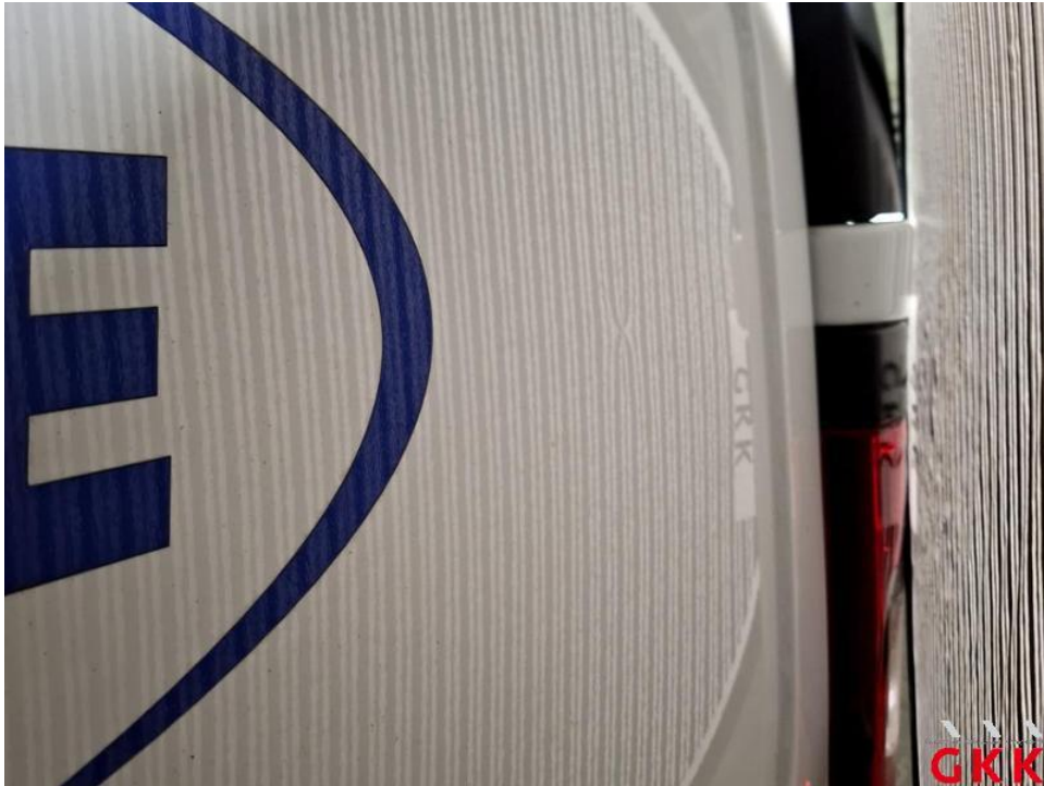
Bild 49. Hecktür rechts, bis 3 Dellen / Bauteil, kalt drücken
