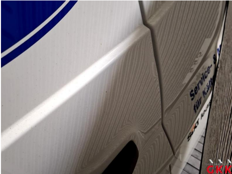
Bild 47. Hecktür links, beschädigt, instand setzen - lackieren
