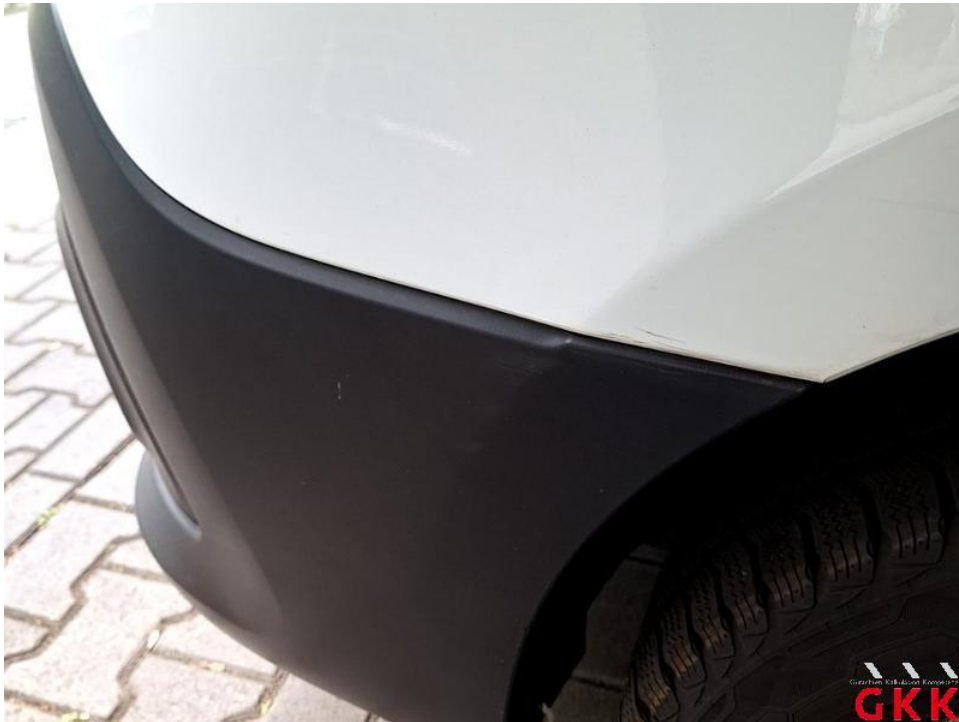
Bild 22. Stoßfänger vorne, Verkleidung -teillackiert-, verkratzt, auslegen, schleifen, polieren
