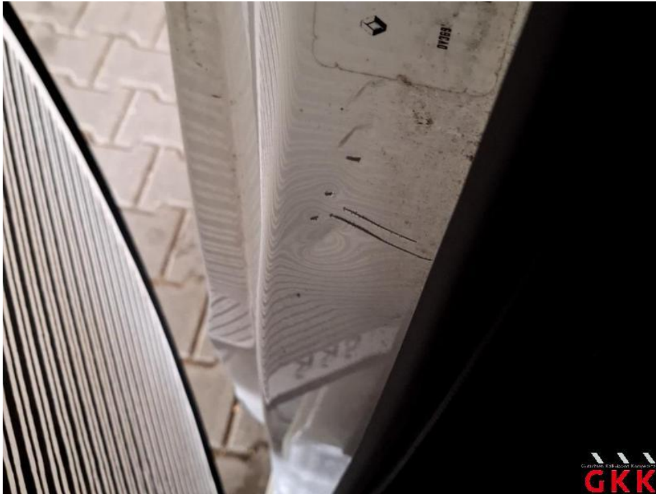
Bild 81. Tür vorne rechts, Einstieg, beschädigt, Smartrepair
