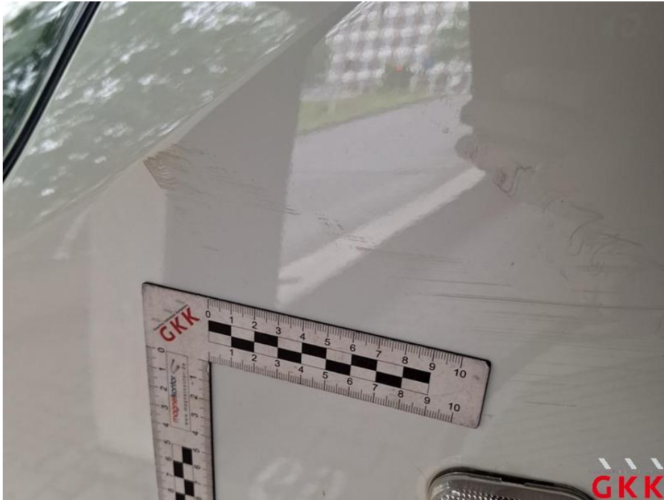
Bild 27. Kotflügel vorne links, beschädigt, instand setzen - lackieren
