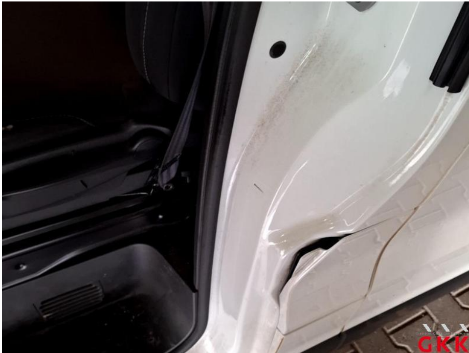
Bild 34. Tür vorne links, Einstieg, verkratzt, Smartrepair
