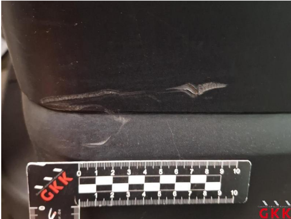
Bild 67. Stoßfänger hinten, Ecke rechts -unlackiert-, verkratzt, Smartrepair
