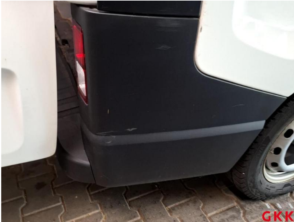
Bild 65. Stoßfänger hinten, Ecke rechts -unlackiert-, verkratzt, Smartrepair
