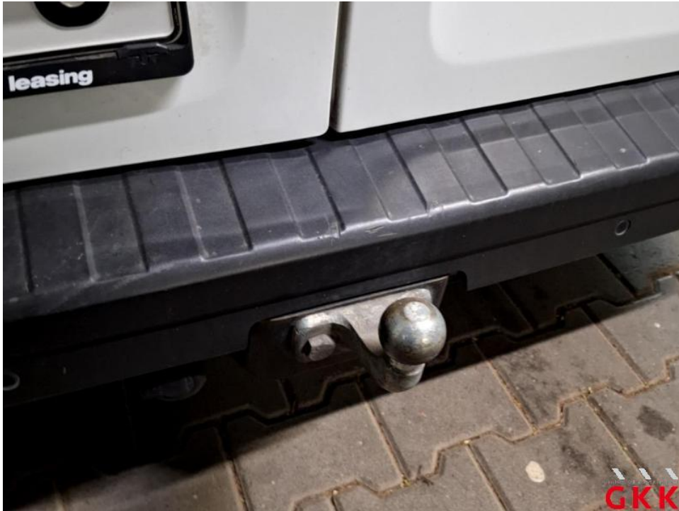
Bild 43. Stoßfänger hinten, Verkleidung -unlackiert-, verkratzt, Smartrepair
