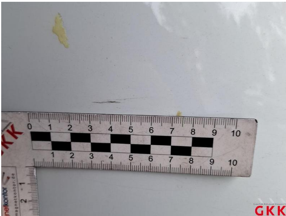
Bild 24. Stoßfänger vorne, Verkleidung -teillackiert-, verkratzt, auslegen, schleifen, polieren
