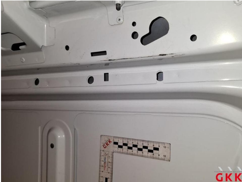
Bild 57. Laderaum, verkratzt, Smartrepair
