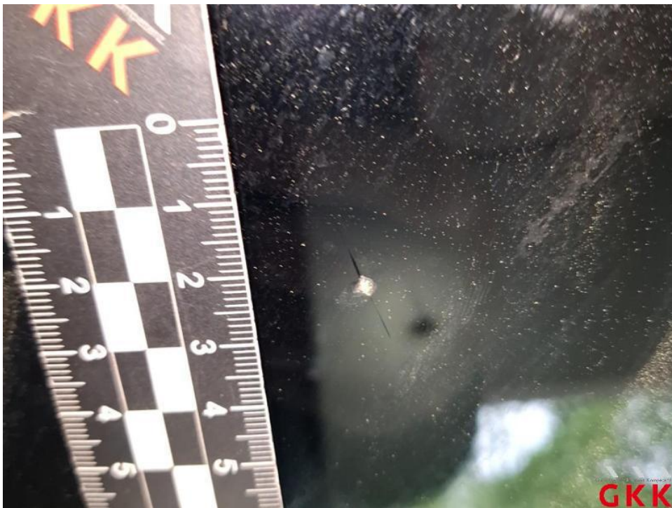
Bild 18. Frontscheibe, mit Regensensor, Steinschlag mit Rissbildung, ersetzen
