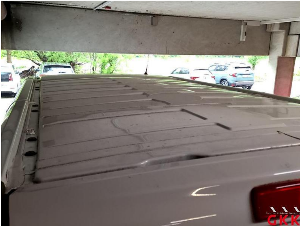
Bild 41. Dach, bis 3 Dellen / Bauteil, kalt drücken
