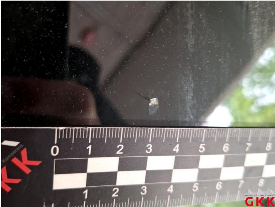
Bild 17. Frontscheibe, mit Regensensor, Steinschlag mit Rissbildung, ersetzen
