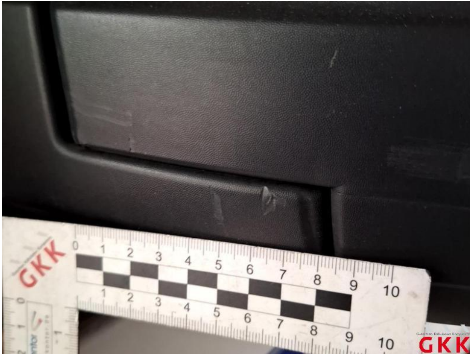
Bild 29. Spiegelgehäuse links, Rahmen, verkratzt, Smartrepair
