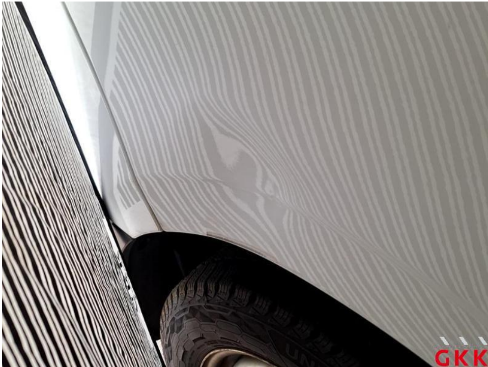
Bild 26. Kotflügel vorne links, beschädigt, instand setzen - lackieren
