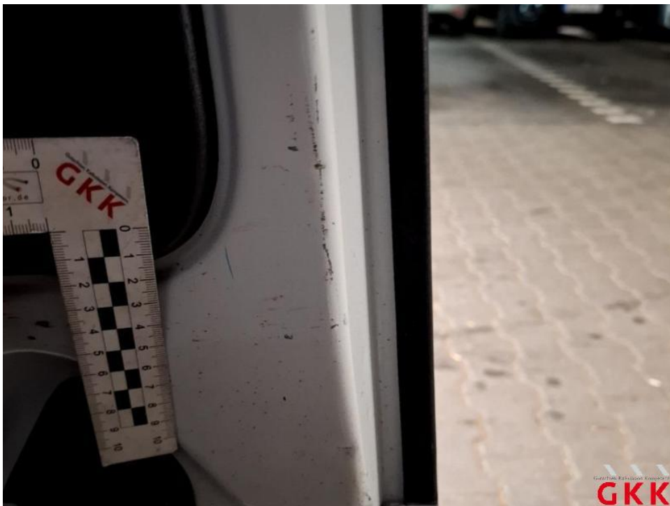
Bild 52. Hecktür rechts, innen, verkratzt, Smartrepair
