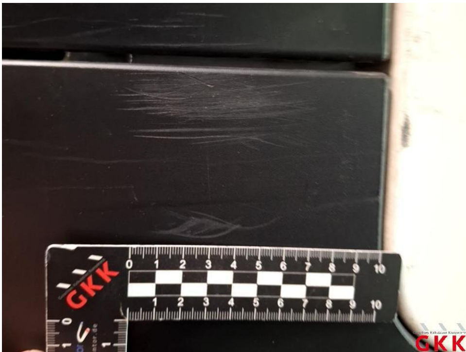
Bild 66. Stoßfänger hinten, Ecke rechts -unlackiert-, verkratzt, Smartrepair
