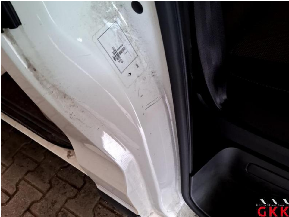
Bild 80. Tür vorne rechts, Einstieg, beschädigt, Smartrepair
