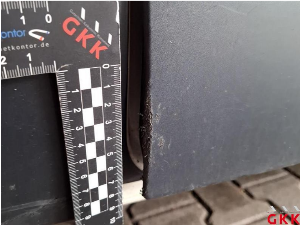
Bild 79. Tür vorne rechts, Leiste -unten-, beschädigt, ersetzen
