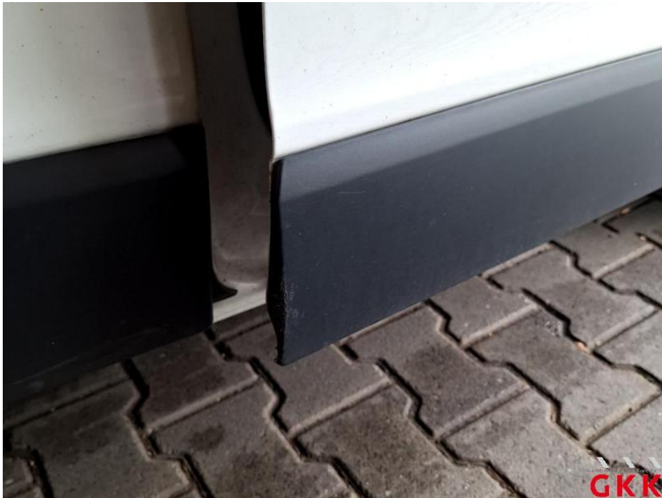
Bild 78. Tür vorne rechts, Leiste -unten-, beschädigt, ersetzen
