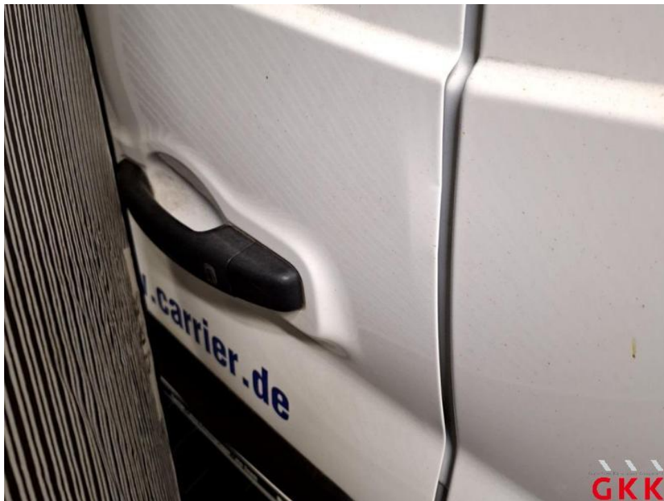
Bild 46. Hecktür links, beschädigt, instand setzen - lackieren
