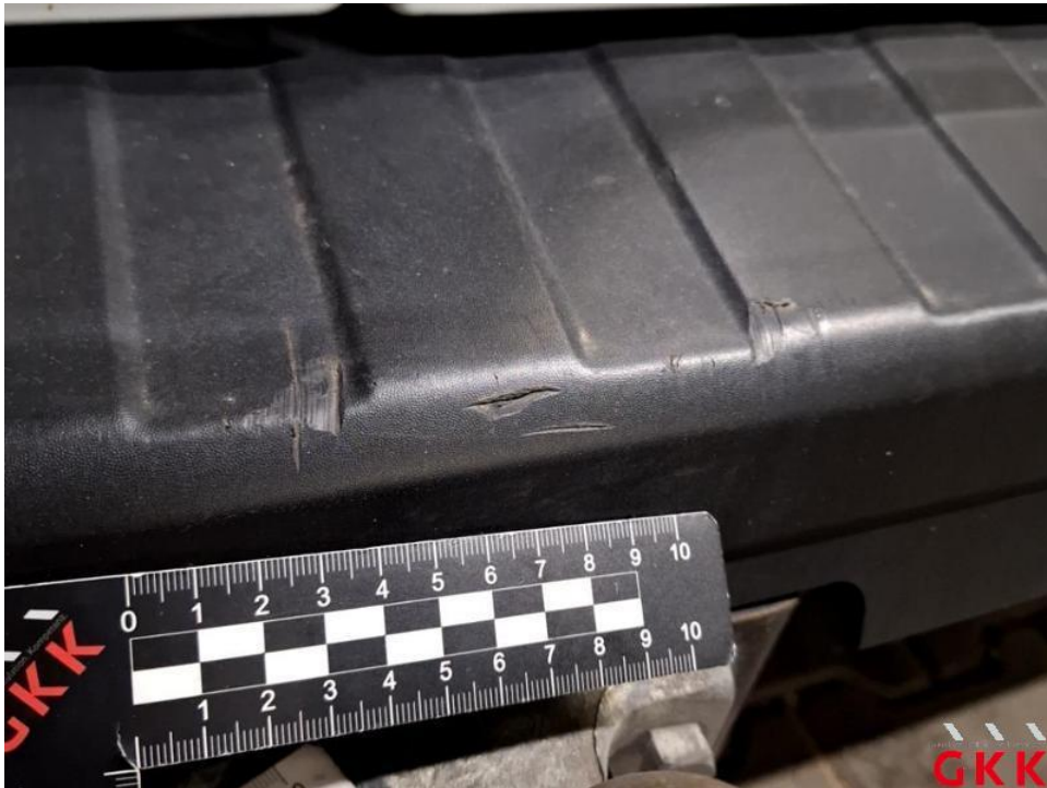
Bild 44. Stoßfänger hinten, Verkleidung -unlackiert-, verkratzt, Smartrepair
