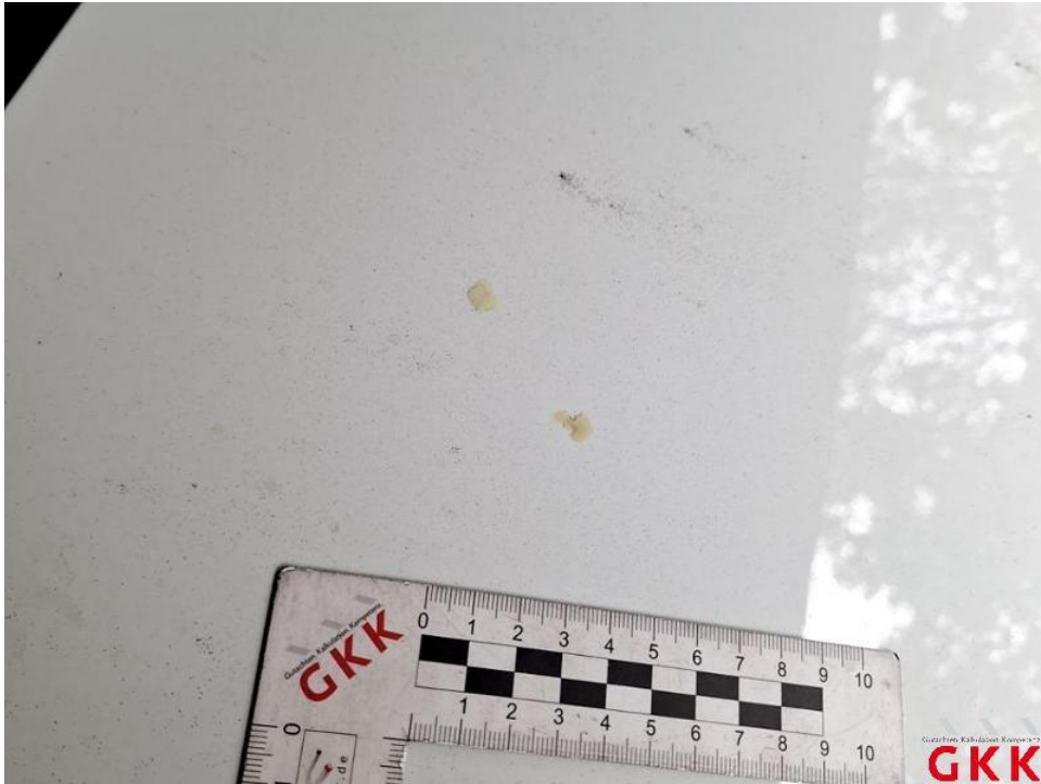
Bild 19. Fahrzeug, außen, Industriestaubanhaftung / Flugrost, aufbereiten
