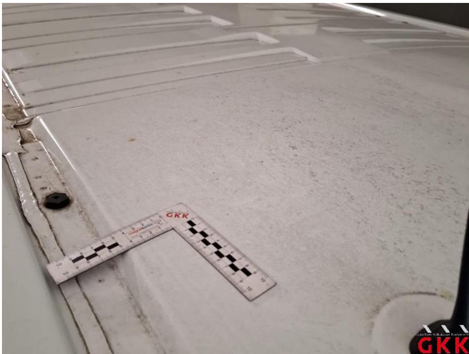
Bild 20. Fahrzeug, außen, Industriestaubanhaftung / Flugrost, aufbereiten
