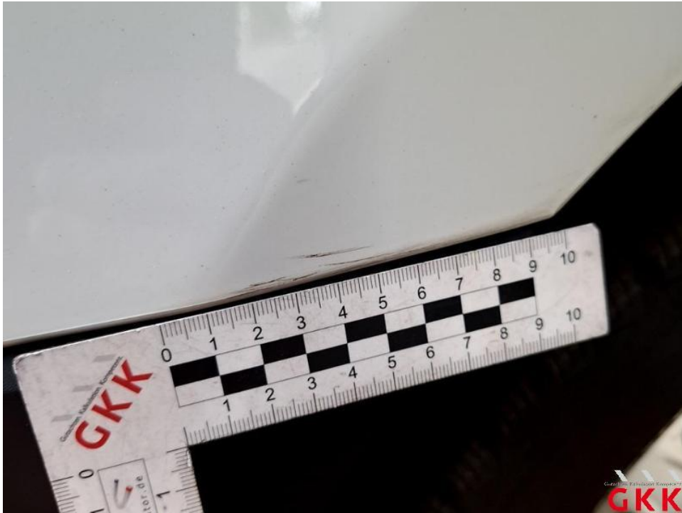
Bild 23. Stoßfänger vorne, Verkleidung -teillackiert-, verkratzt, auslegen, schleifen, polieren
