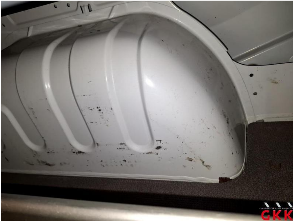
Bild 61. Radhaus hinten rechts, verkratzt, lackieren
