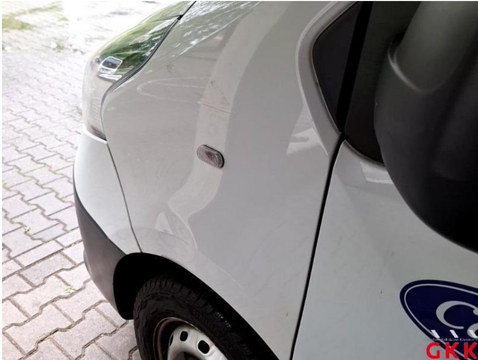
Bild 25. Kotflügel vorne links, beschädigt, instand setzen - lackieren
