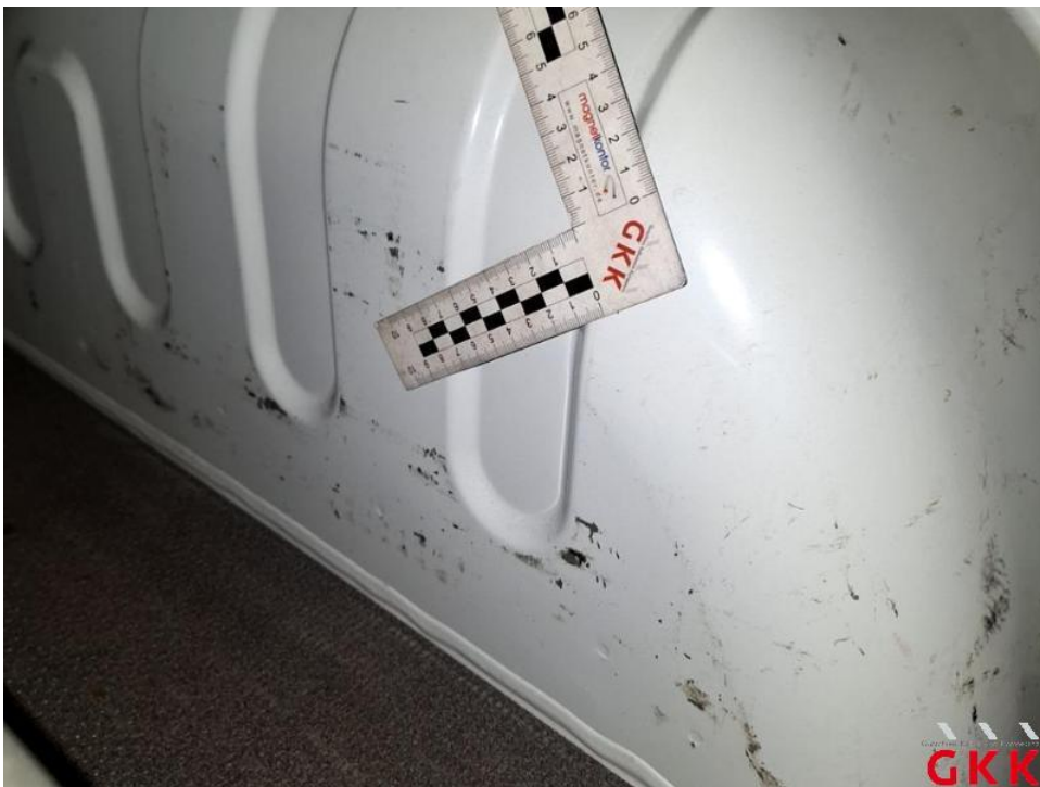
Bild 62. Radhaus hinten rechts, verkratzt, lackieren
