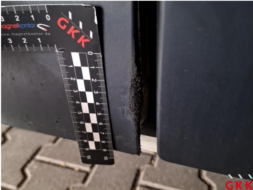
Bild 32. Tür vorne links, Leiste -unten-, beschädigt, ersetzen
