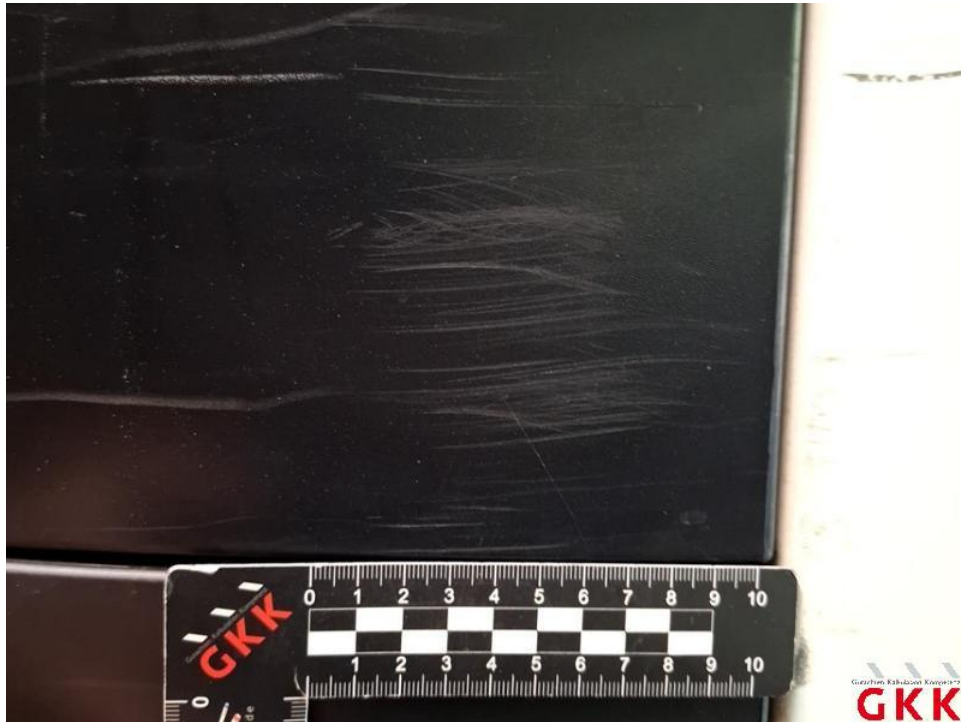
Bild 64. D- Säule rechts, Abdeckung -unlackiert-, beschädigt, ersetzen
