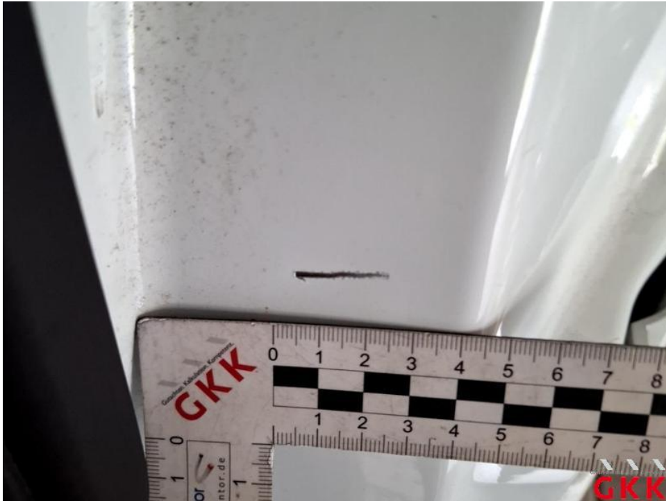
Bild 35. Tür vorne links, Einstieg, verkratzt, Smartrepair
