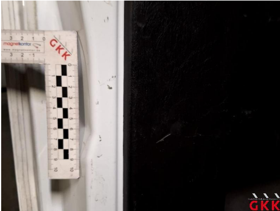
Bild 55. Hecktür links, innen, verkratzt, Smartrepair
