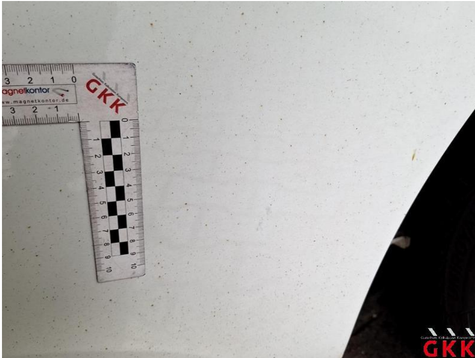
Bild 21. Fahrzeug, außen, Industriestaubanhaftung / Flugrost, aufbereiten
