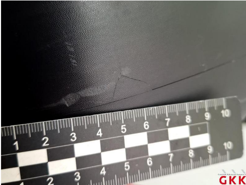
Bild 77. Spiegelgehäuse rechts, Kappe -unlackiert-, gerissen, ersetzen
