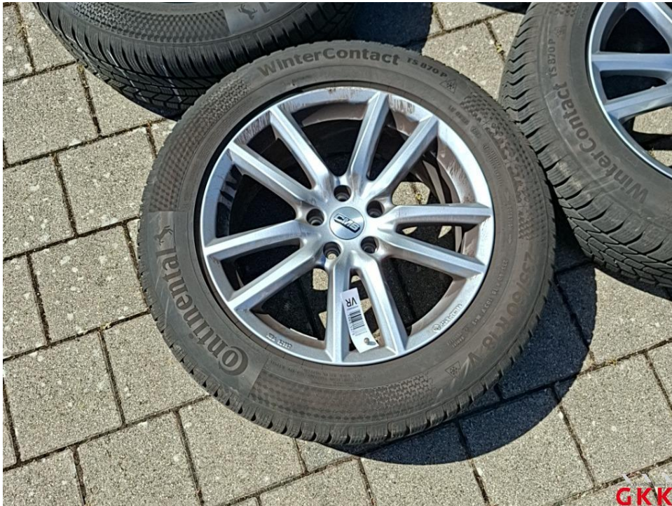
Bild 19. LM-Rad, 1 x beiliegend, Materialabtrag, ersetzen
