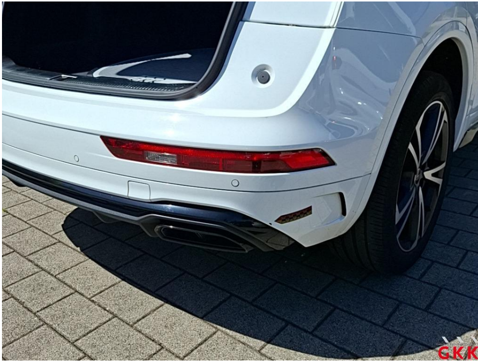
Bild 31. Stoßfänger hinten, Verkleidung unterhalb -lackiert-, beschädigt, instand setzen - lackieren
