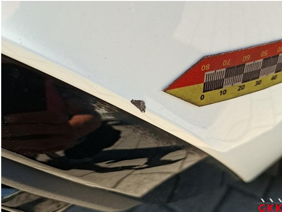
Bild 32. Stoßfänger hinten, Verkleidung unterhalb -lackiert-, beschädigt, instand setzen - lackieren
