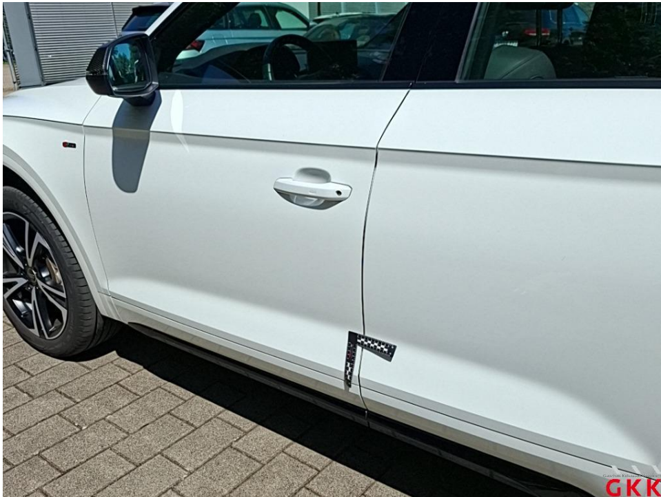
Bild 21. Tür vorne links, Kante, beschädigt, auslegen, schleifen, polieren
