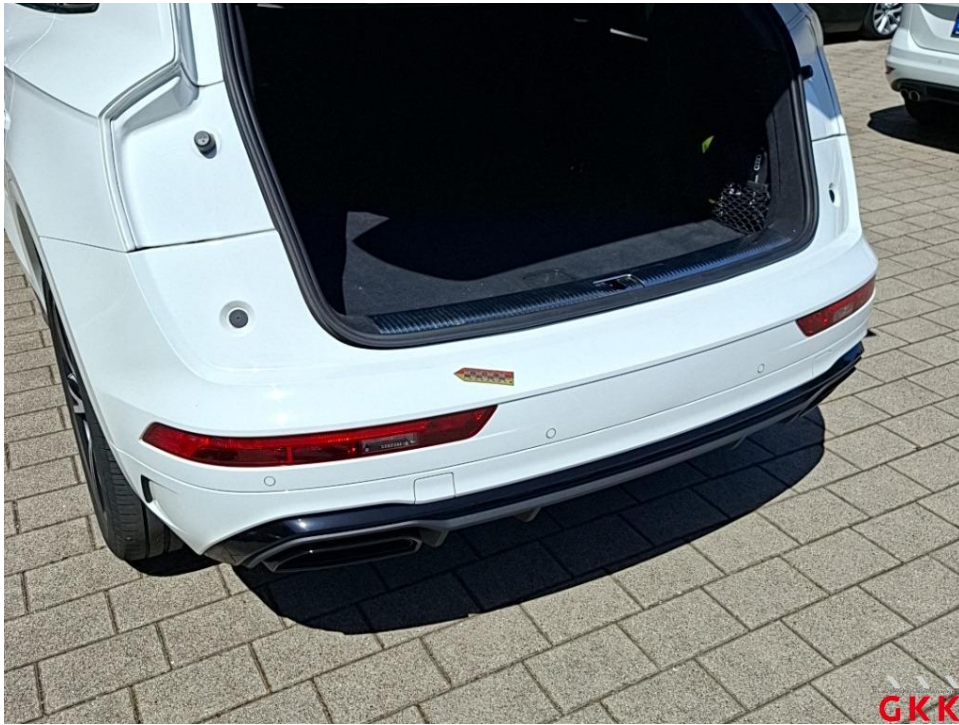
Bild 37. Stoßfänger hinten, Verkleidung oberhalb -lackiert-, verkratzt, lackieren
