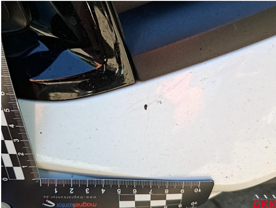
Bild 30. Stoßfänger vorne, Verkleidung -lackiert-, Steinschlag, lackieren
