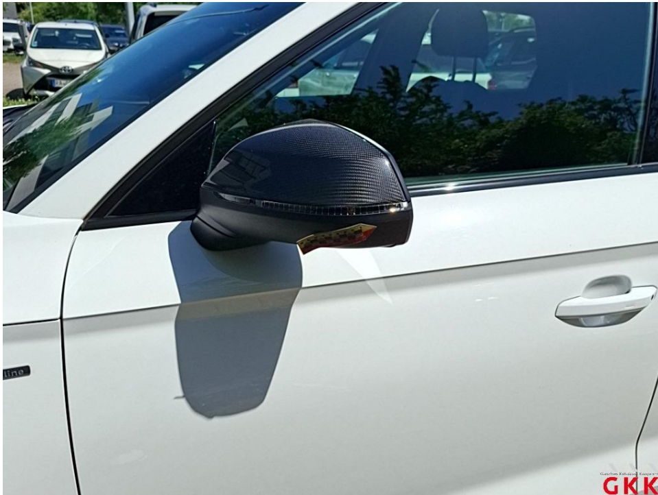
Bild 23. Spiegelgehäuse links, Blende -unlackiert-, verkratzt, Smartrepair
