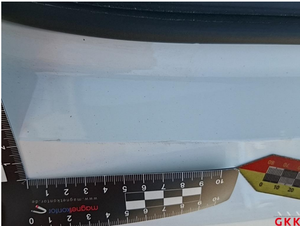
Bild 38. Stoßfänger hinten, Verkleidung oberhalb -lackiert-, verkratzt, lackieren
