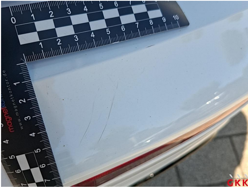
Bild 39. Stoßfänger hinten, Verkleidung oberhalb -lackiert-, verkratzt, lackieren
