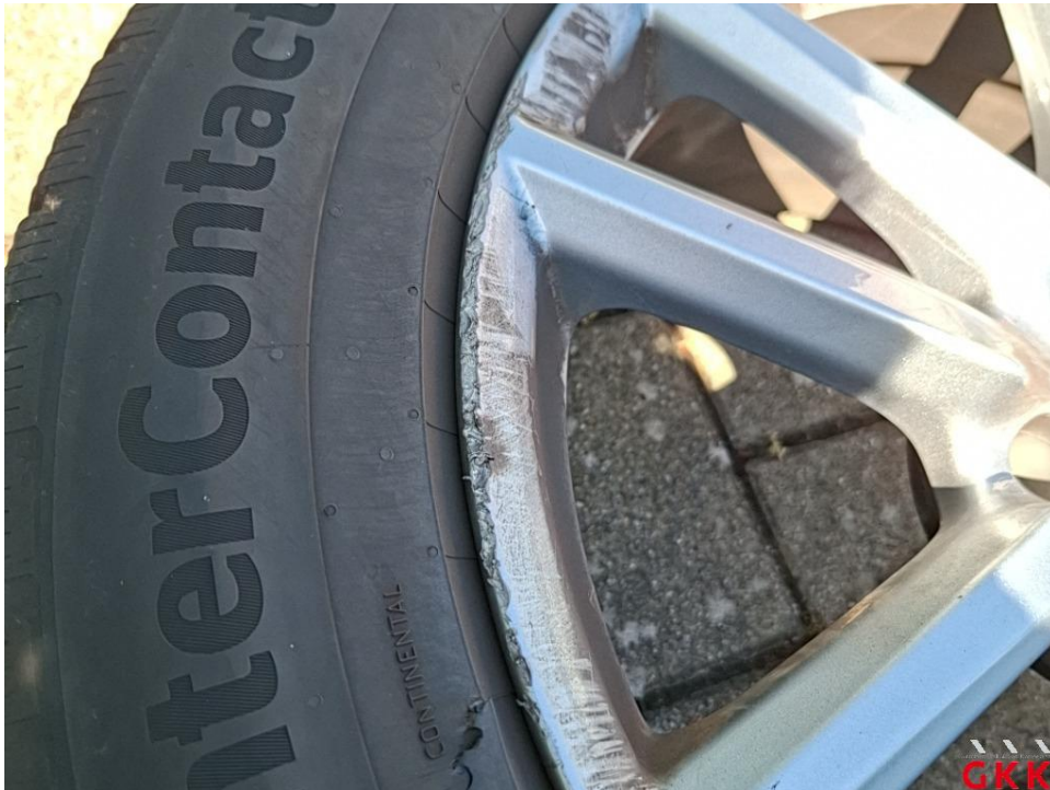
Bild 20. LM-Rad, 1 x beiliegend, Materialabtrag, ersetzen
