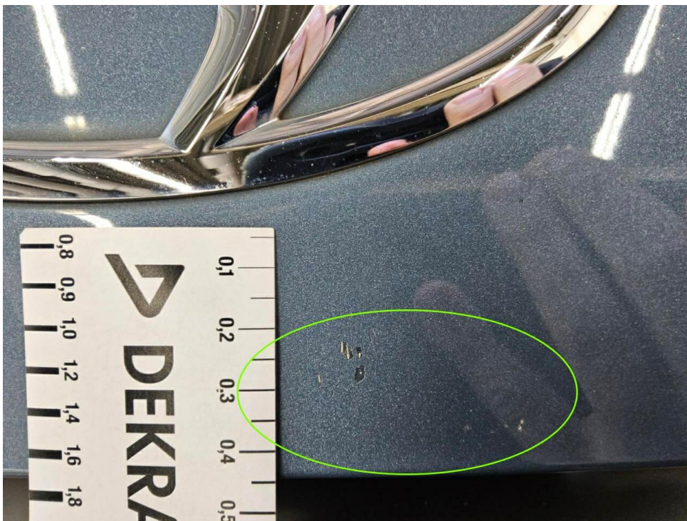
Bild 14 : Motorhaube, verschrammt, instandsetzen und lackieren mit Lackaufbau
