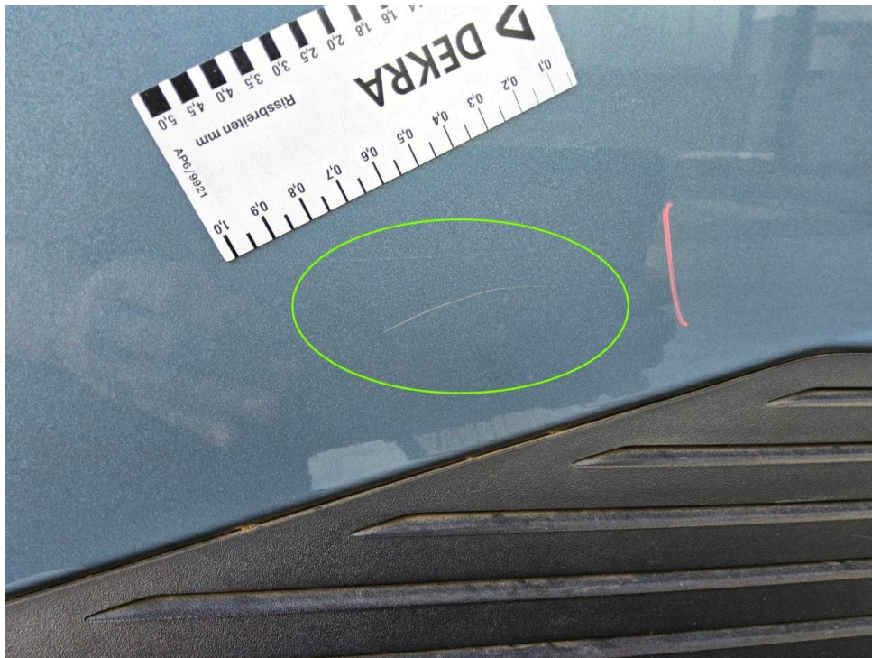
Bild 9 : Tür hinten rechts Lackierung, verschrammt, lackieren mit Lackaufbau
