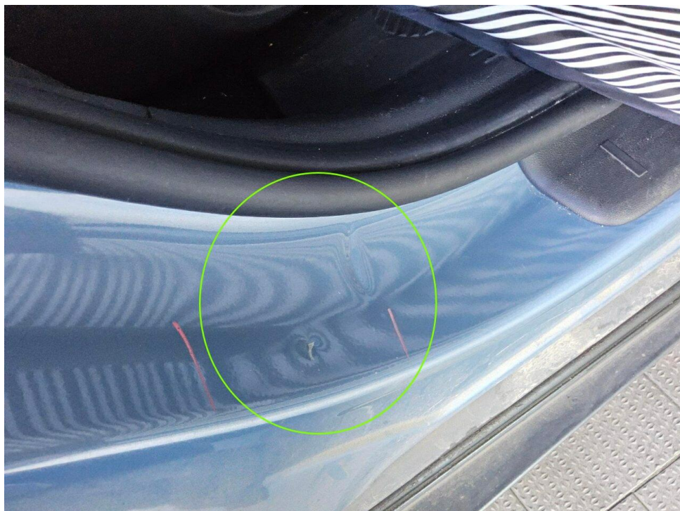
Bild 10 : Tür hinten links Einstieg, eingedellt, smart repair
