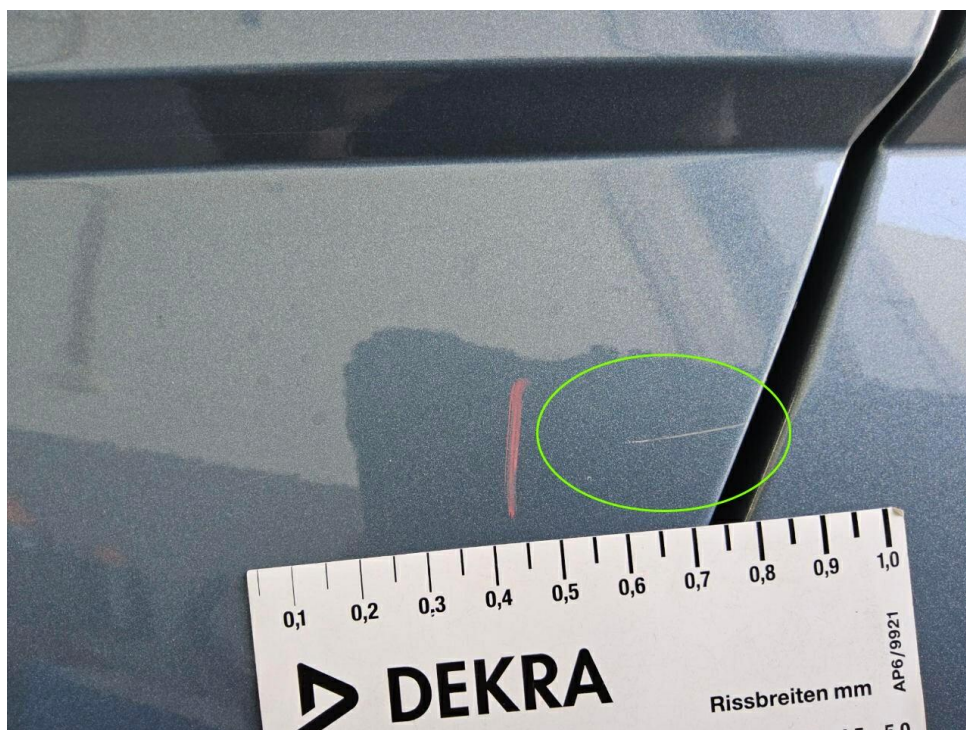
Bild 20 : Tür hinten links Lackierung, zerkratzt, polieren
