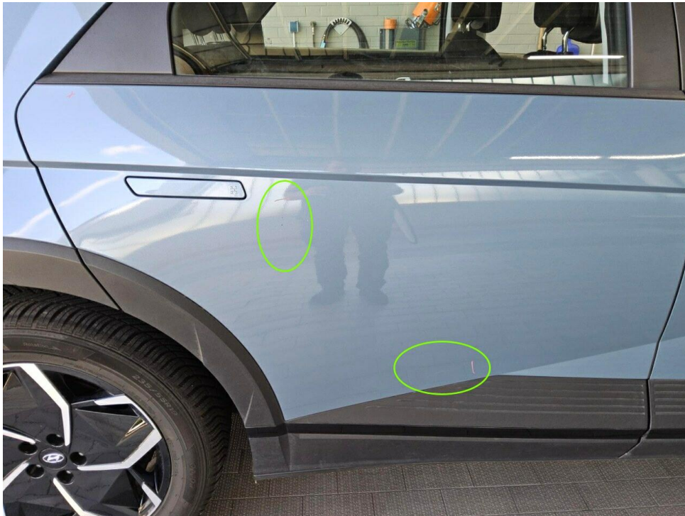
Bild 7 : Tür hinten rechts Lackierung, verschrammt, lackieren mit Lackaufbau
