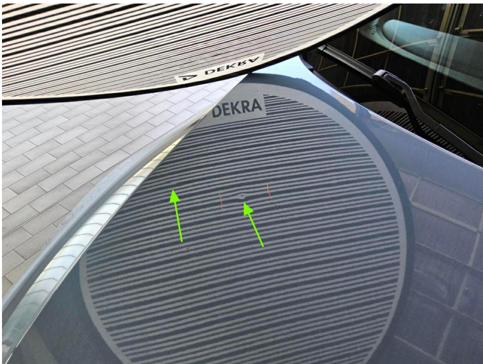
Bild 12 : Motorhaube, mehrfach eingedellt, instandsetzen und lackieren mit Lackaufbau
