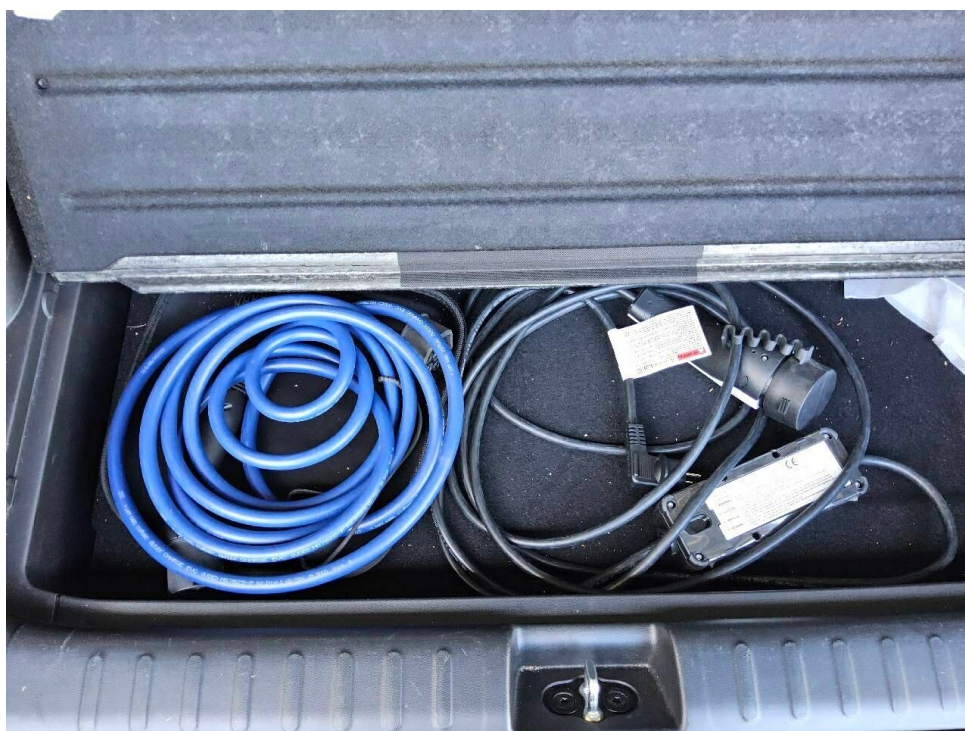
Bild 6 : Ladekabel beim E-Fahrzeug
