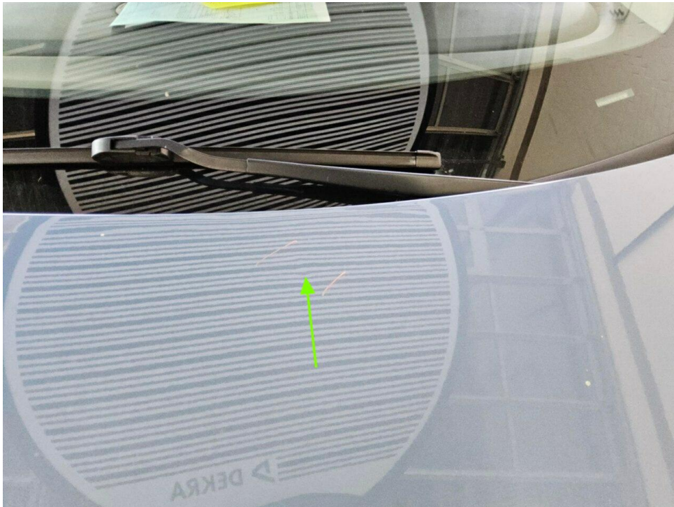
Bild 13 : Motorhaube, mehrfach eingedellt, instandsetzen und lackieren mit Lackaufbau
