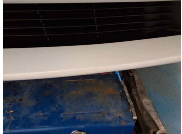
Beschädigung #1: Stossfänger vorn: Stossfänger vorn - Lackmangel - Smart Repair
