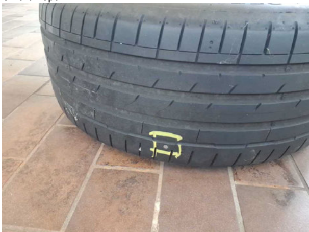
Beschädigung #3: 2.Radsatz: 1 Reifen - beschädigt - erneuern
