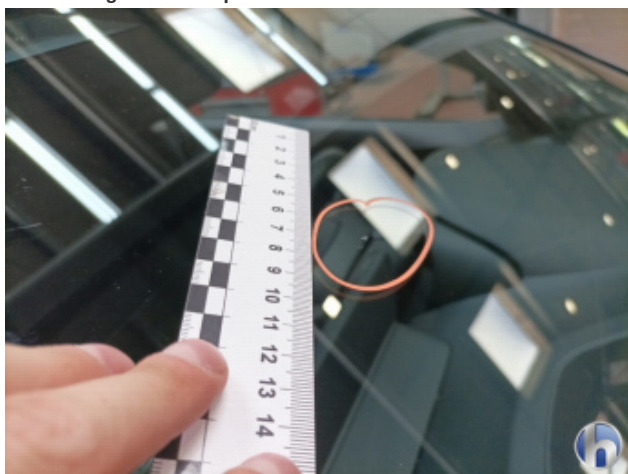
5. Windschutzscheibe Steinschlag - Smart Repair
