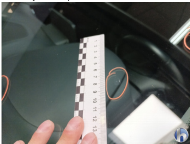
5. Windschutzscheibe Steinschlag - Smart Repair
