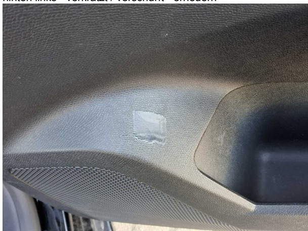
Beschädigung #12: Verkleidungen/Abdeckungen: Türverkleidung vorn rechts - gebrochen / gerissen - erneuern
