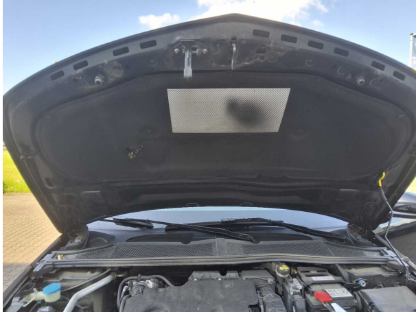
Beschädigung #8: Motorhaube: Dämmmatte - Marderschaden - erneuern
