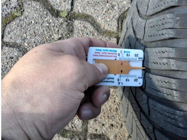
Beschädigung #1: 2.Radsatz: 2 Reifen - verschlissen
