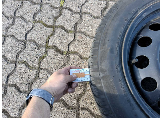
Beschädigung #1: 2.Radsatz: 2 Reifen - verschlissen
