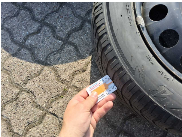
Beschädigung #1: 2.Radsatz: 2 Reifen - verschlissen
