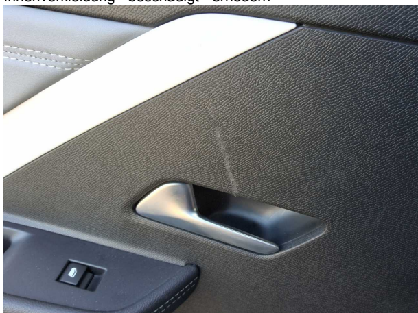
Beschädigung #11: Verkleidungen/Abdeckungen: Türverkleidung hinten links - verkratzt / verschürft - erneuern
