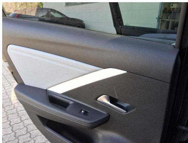
Beschädigung #11: Verkleidungen/Abdeckungen: Türverkleidung hinten links - verkratzt / verschürft - erneuern
