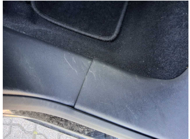
Beschädigung #9: Seitenwand links: Einstieg (Verkleidung Einstieg hinten links) - beschädigt - erneuern
