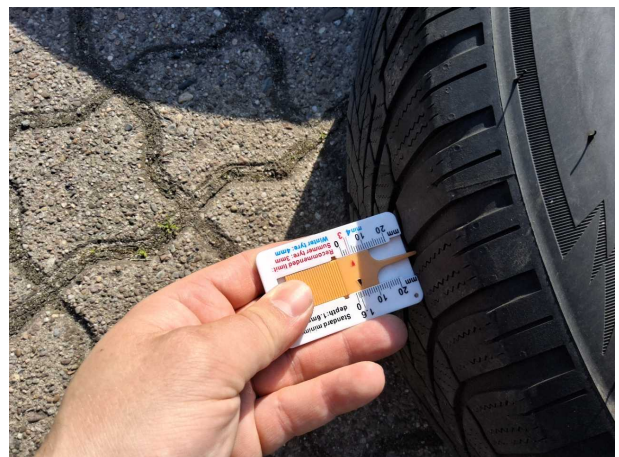
Beschädigung #1: 2.Radsatz: 2 Reifen - verschlissen
