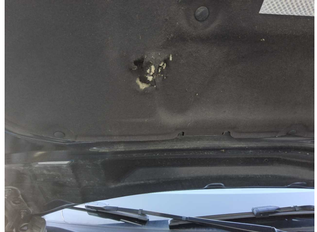
Beschädigung #8: Motorhaube: Dämmmatte - Marderschaden - erneuern
