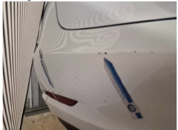
Beschädigung #16: Stossfänger hinten: Stossfänger hinten - beschädigt - erneuern
