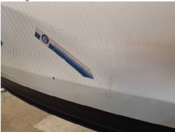
Beschädigung #16: Stossfänger hinten: Stossfänger hinten - beschädigt - erneuern
