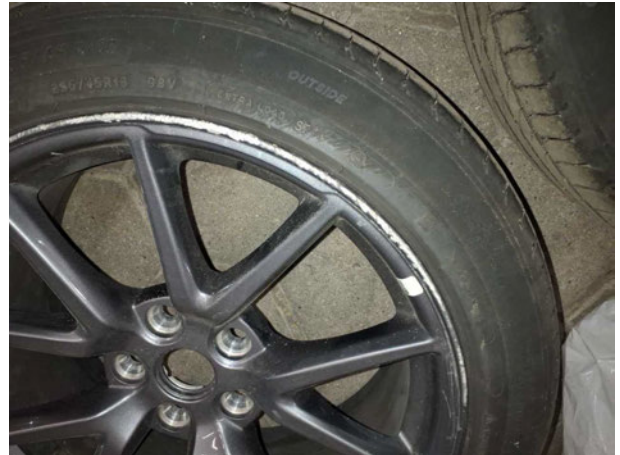
Beschädigung #9: 2.Radsatz: 1 Leichtmetallfelge - beschädigt - erneuern
