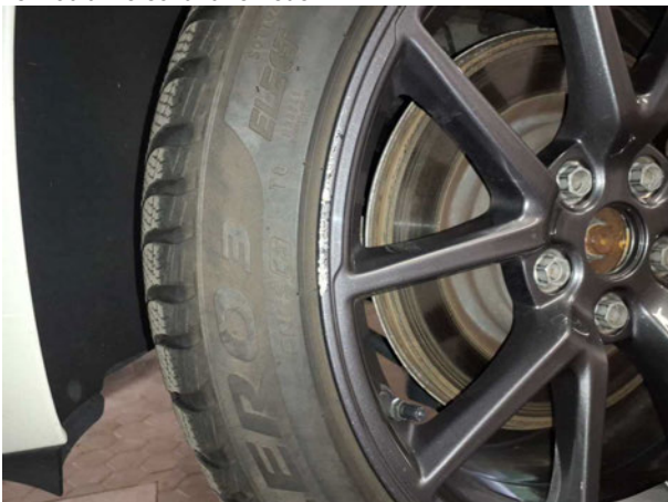
Beschädigung #10: Rad/Reifen: Leichtmetallfelge hinten links - verkratzt / verschürft - erneuern
