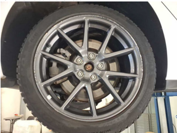
Beschädigung #13: Bremsanlage: Bremsscheiben hinten - Korrosion - erneuern
