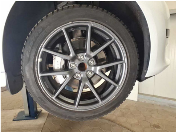
Beschädigung #12: Rad/Reifen: Leichtmetallfelge vorn rechts - verkratzt / verschürft - erneuern
