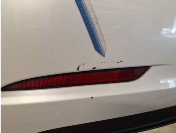
Beschädigung #16: Stossfänger hinten: Stossfänger hinten - beschädigt - erneuern
