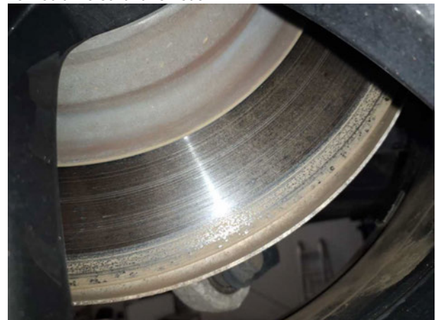
Beschädigung #13: Bremsanlage: Bremsscheiben hinten - Korrosion - erneuern
