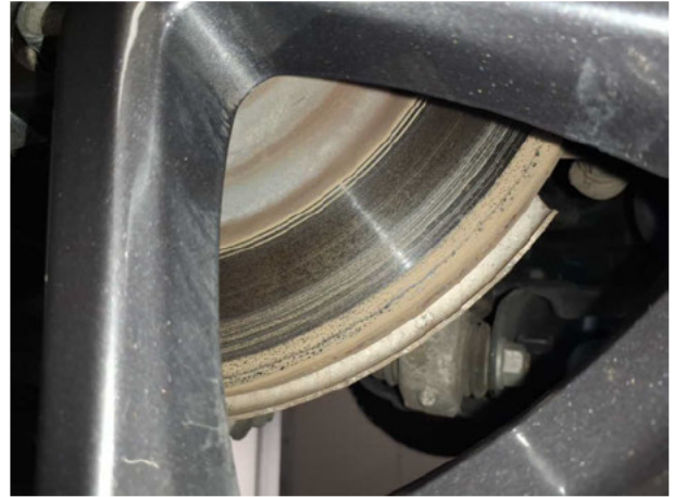
Beschädigung #13: Bremsanlage: Bremsscheiben hinten - Korrosion - erneuern
