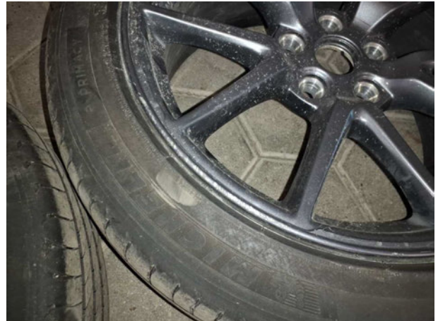
Beschädigung #6: 2.Radsatz: 1 Leichtmetallfelge - beschädigt - Wertminderung
