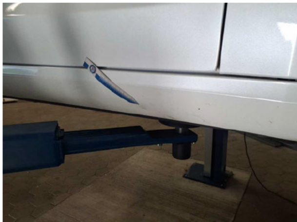
Beschädigung #2: Schweller rechts: Schweller - Delle(n) - sanft instandsetzen
