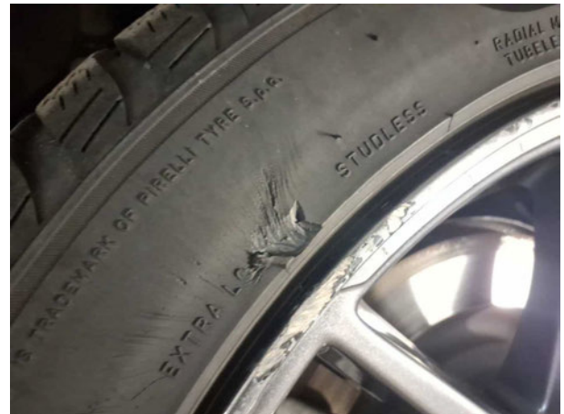
Beschädigung #4: Rad/Reifen: Reifen hinten - beschädigt - erneuern
