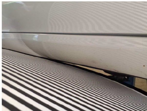
Beschädigung #2: Schweller rechts: Schweller - Delle(n) - sanft instandsetzen
