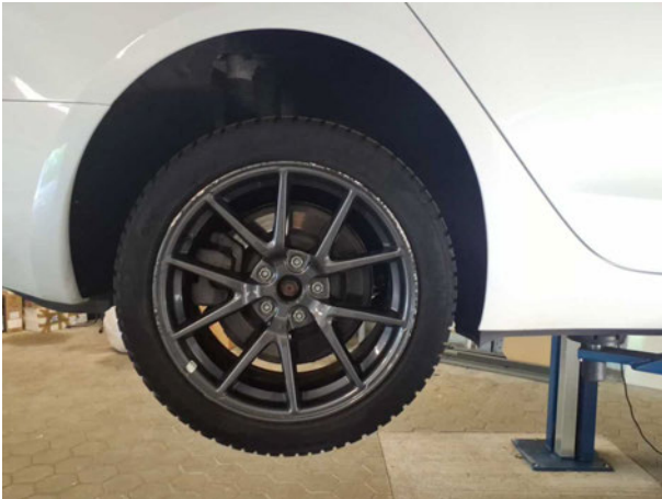
Beschädigung #11: Rad/Reifen: Leichtmetallfelge hinten rechts - verkratzt / verschürft - erneuern
