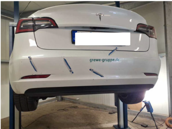
Beschädigung #16: Stossfänger hinten: Stossfänger hinten - beschädigt - erneuern
