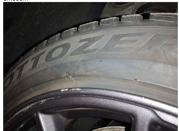
Beschädigung #5: Rad/Reifen: Reifen vorn links - beschädigt - erneuern
