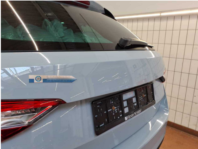
Damage 2: Boot lid / rear door: Lettering (Liegt im Auto) - Missing - Un- / install
