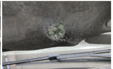
Geräuschdämmung Motorhaube / - / Gebrochen
