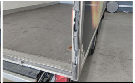
Türdichtung / Hinten Rechts / Gebrochen
