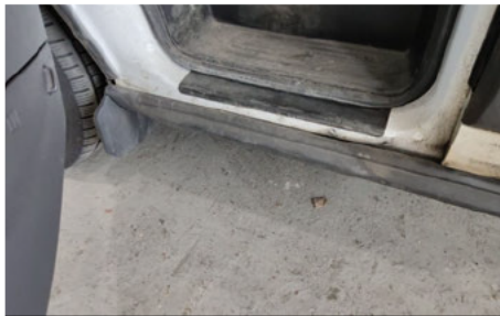
Türdichtung / Vorne Links / Fehlt
