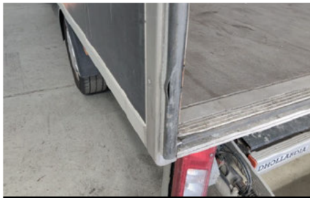
Türdichtung / Hinten Links / Gebrochen
