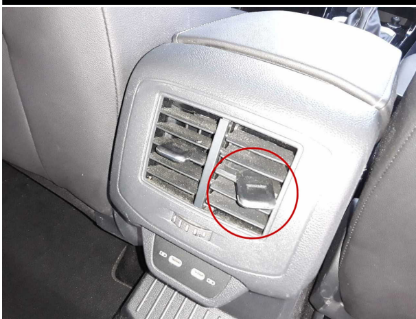
Beschädigung #3: Instrumententafel: Mittelkonsole hinten (Lüftungsdüse re.) - gebrochen / gerissen - erneuern
