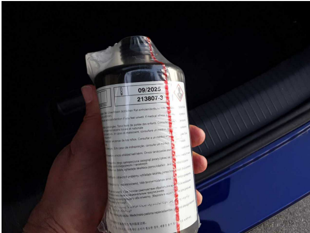
Beschädigung #1: Ausrüstung: Tirefit Füllmittel - abgelaufen - erneuern
