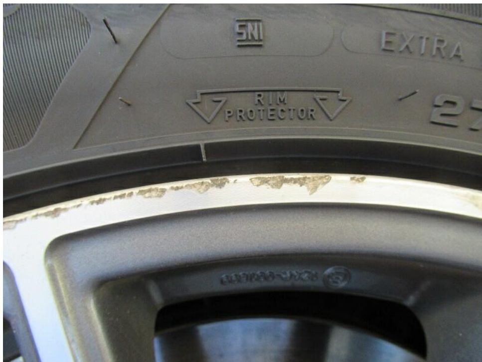
Bild 30 : Leichtmetallfelge hinten rechts beschädigt verschrammt.
