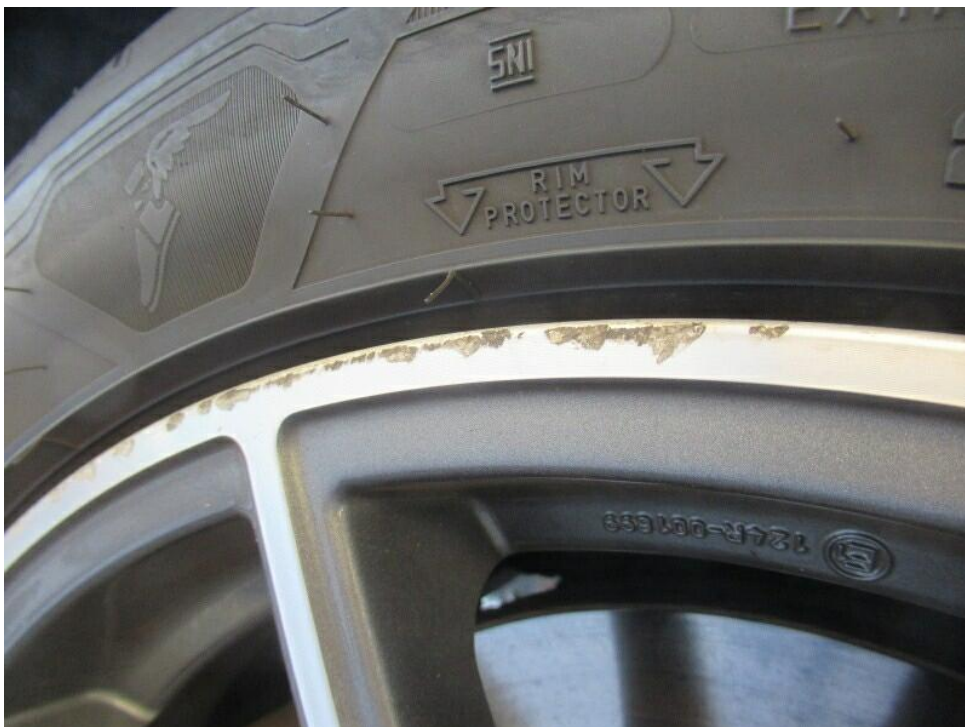
Bild 32 : Leichtmetallfelge hinten rechts beschädigt verschrammt.
