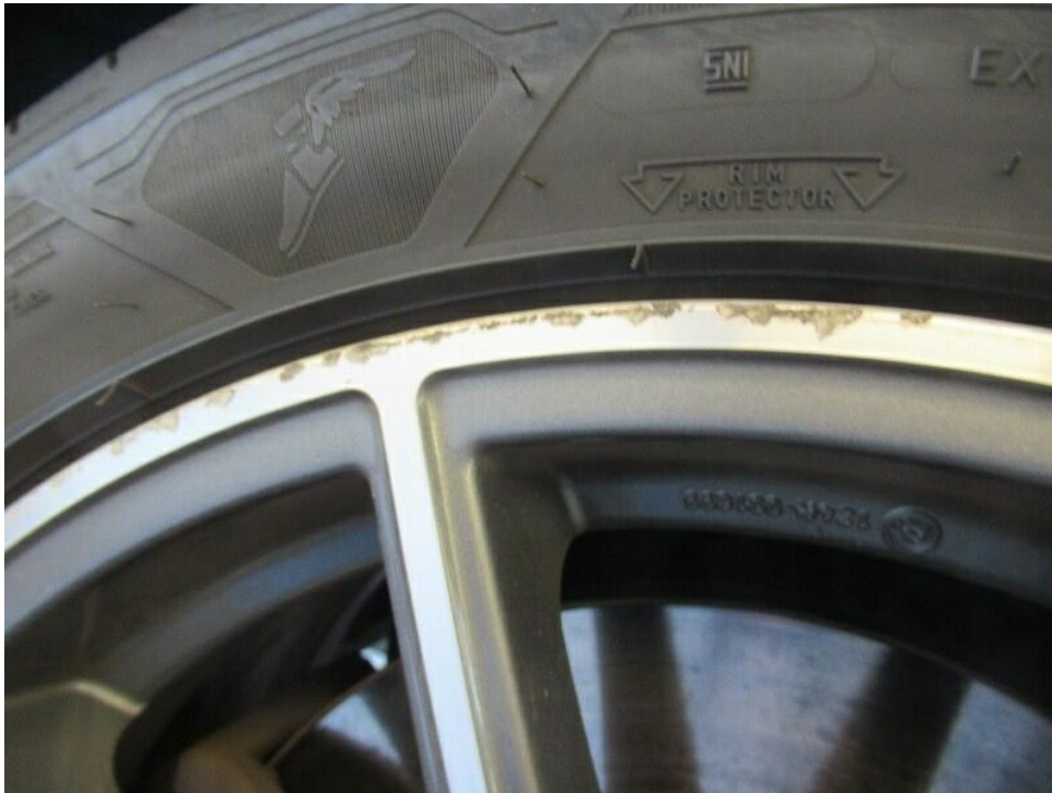
Bild 33 : Leichtmetallfelge hinten rechts beschädigt verschrammt.
