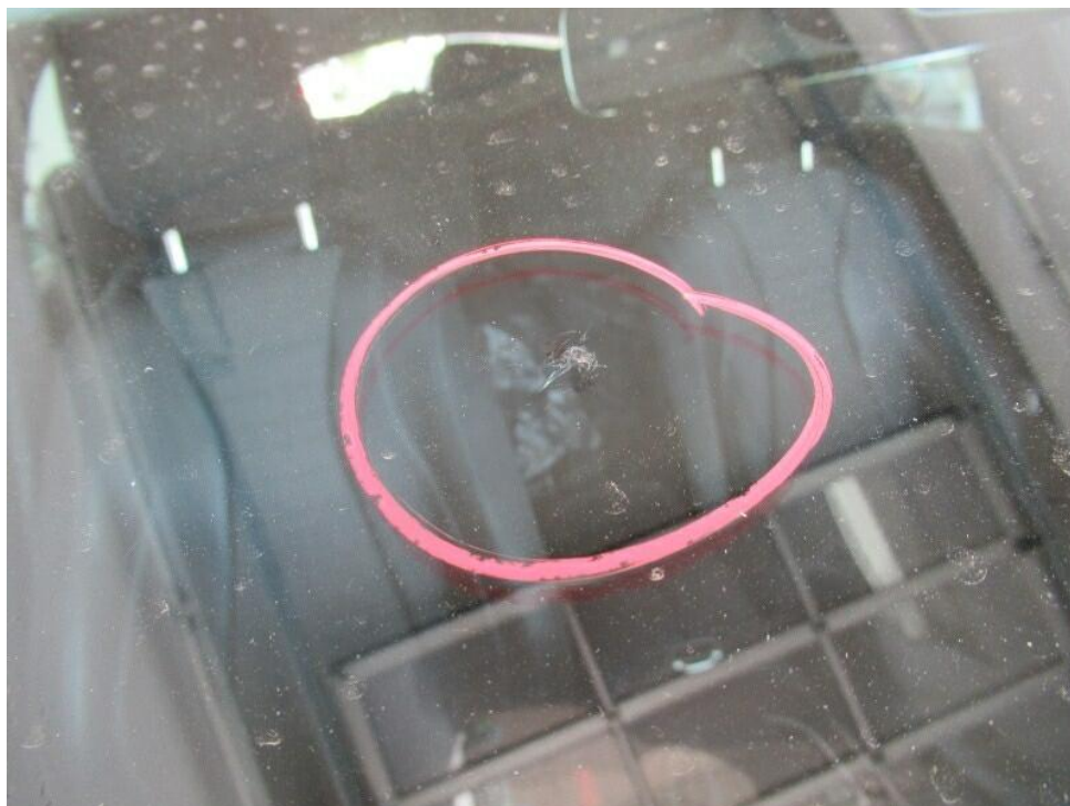
Bild 42 : Frontscheibe, Steinschlag, instandsetzen
