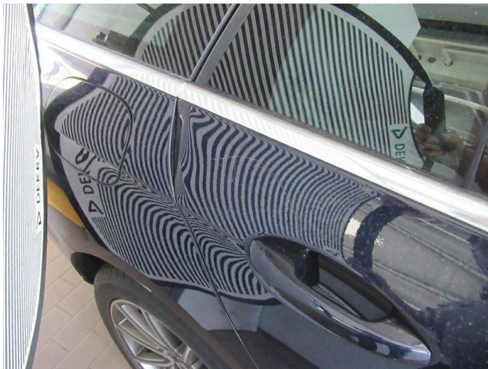
Bild 19 : Tür hinten rechts beschädigt eingedrückt verkratzt.
