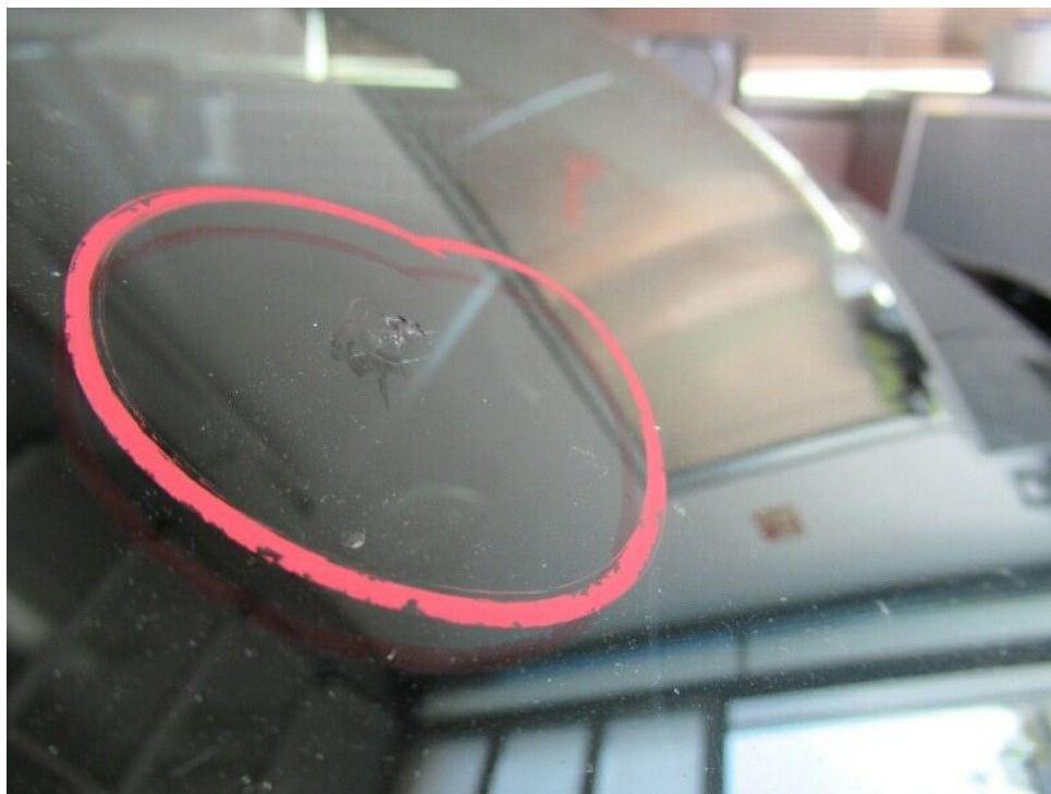
Bild 41 : Frontscheibe, Steinschlag, instandsetzen
