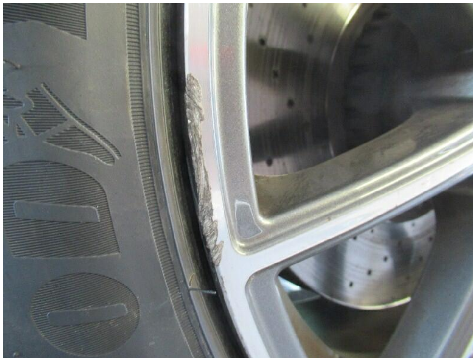
Bild 22 : Leichtmetallfelge vorne links beschädigt verschrammt.
