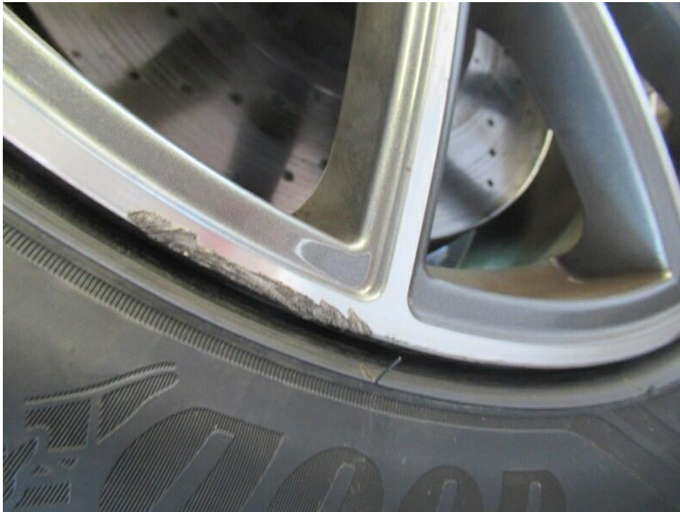
Bild 23 : Leichtmetallfelge vorne links beschädigt verschrammt.
