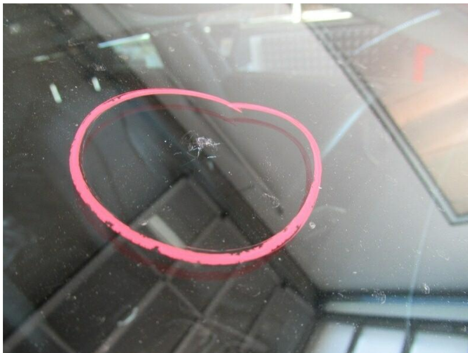
Bild 40 : Frontscheibe, Steinschlag, instandsetzen
