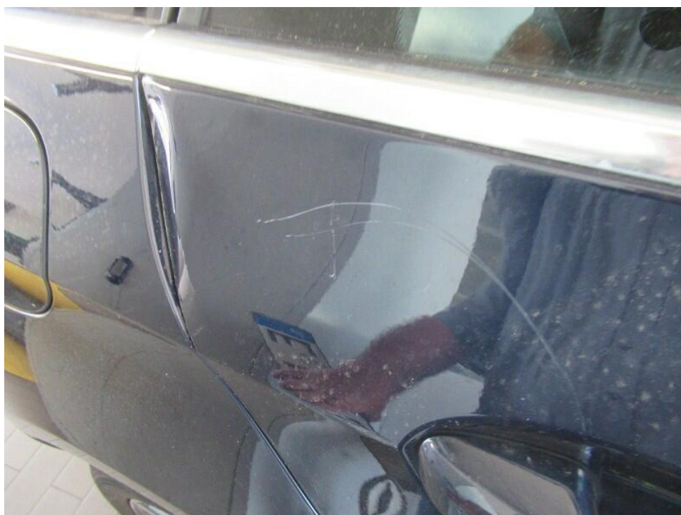
Bild 20 : Tür hinten rechts beschädigt eingedrückt verkratzt.
