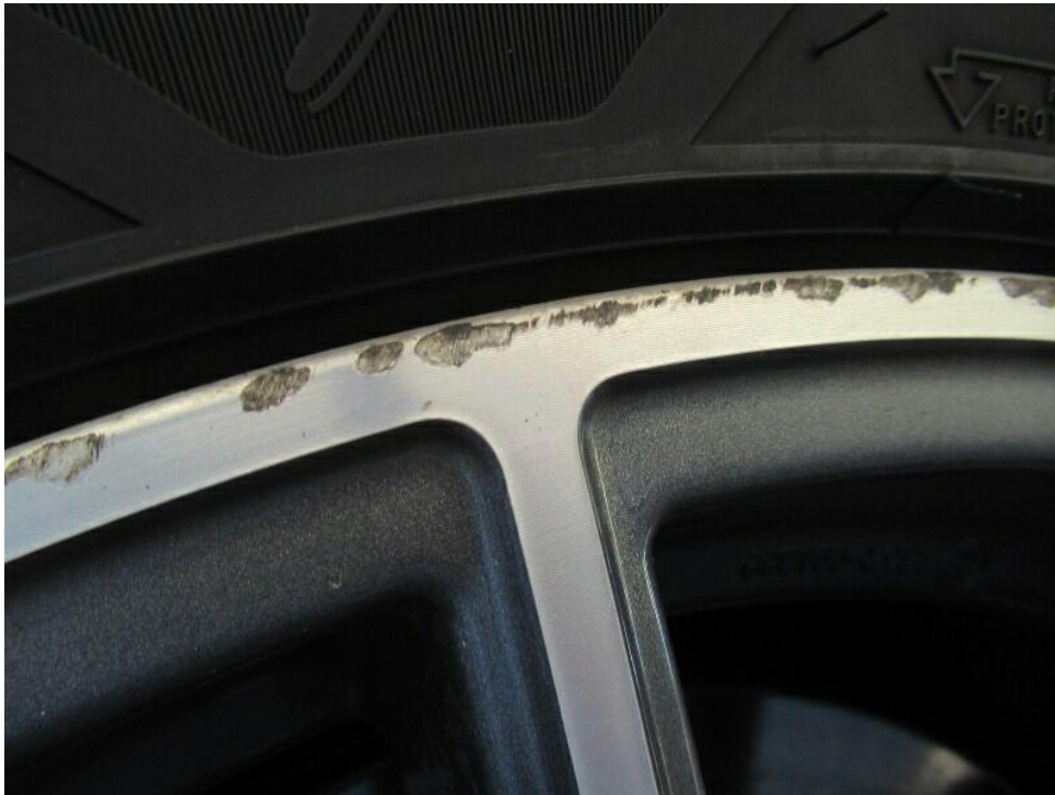
Bild 31 : Leichtmetallfelge hinten rechts beschädigt verschrammt.
