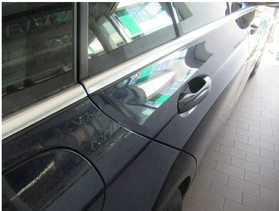
Bild 21 : Tür hinten rechts beschädigt eingedrückt verkratzt.
