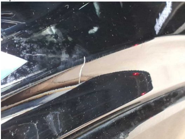
Beschädigung #11: Seitenwand rechts: Einstieg - Kratzer - Smart Repair
