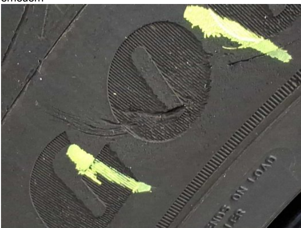
Beschädigung #14: Rad/Reifen: Reifen hinten rechts - gebroche... gerissen - erneuern
