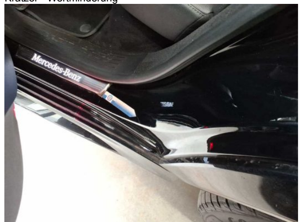
Beschädigung #7: Seitenwand links: Einstieg - Kratzer - Sm... Repair
