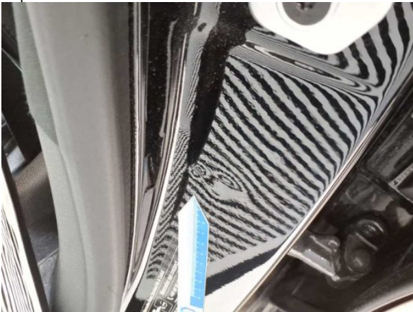
Beschädigung #8: Karosserie: B-Säule links - Delle(n) - sanft instandsetzen
