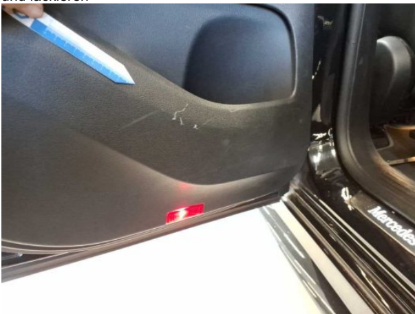
Beschädigung #18: Verkleidungen/Abdeckungen: Türverkleidung hinten links - Kratzer - erneuern
