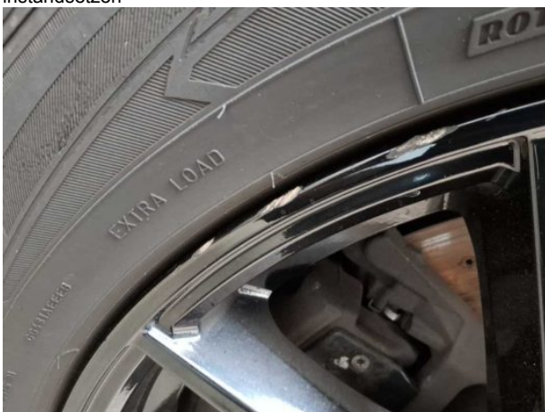
Beschädigung #6: Rad/Reifen: Leichtmetallfelge vorn rechts - Kratzer - Wertminderung
