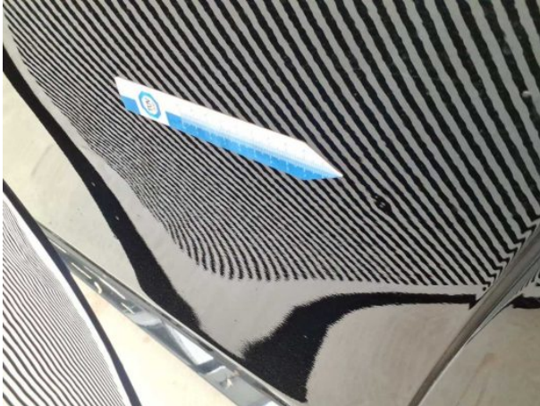
Beschädigung #4: Tür vorn links: Tür - Delle(n) - sanft instandsetzen
