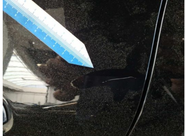
Beschädigung #17: Tür hinten links: Tür - Kratzer - instandsetzen und lackieren
