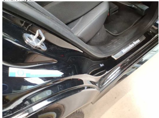
Beschädigung #11: Seitenwand rechts: Einstieg - Kratzer - Smart Repair
