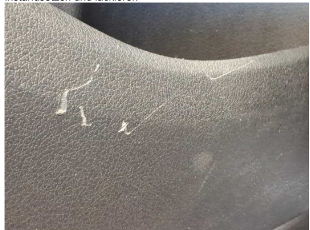
Beschädigung #18: Verkleidungen/Abdeckungen: Türverkleidung hinten links - Kratzer - erneuern
