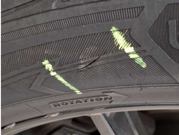
Beschädigung #15: Rad/Reifen: Reifen vorn rechts - gebrochen / gerissen - erneuern
