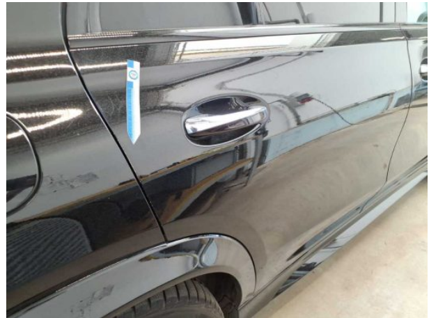
Beschädigung #10: Tür hinten rechts: Türkante - Kratzer - Smart Repair
