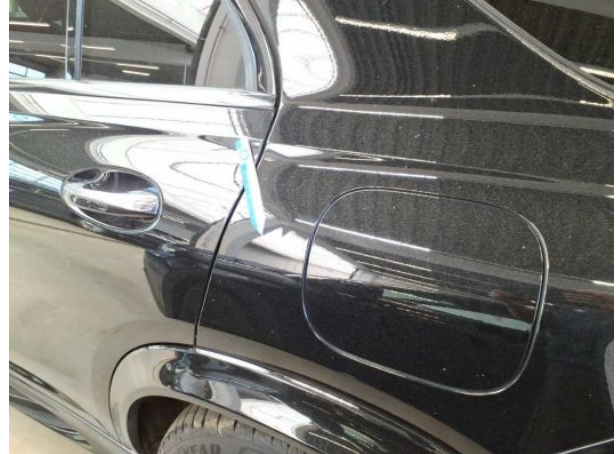
Beschädigung #5: Seitenwand links: Seitenwand - Delle(n) - sanft instandsetzen
