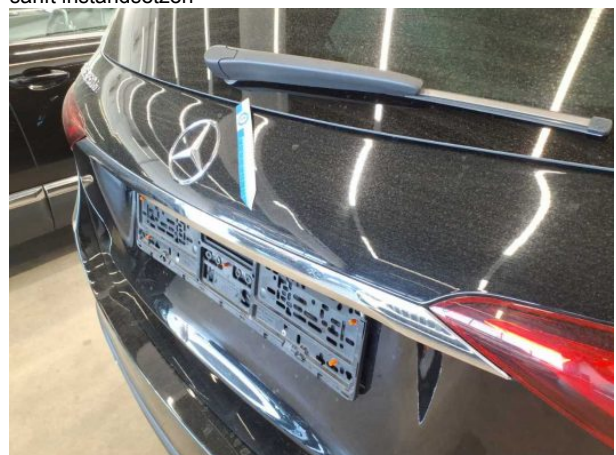
Beschädigung #9: Heckklappe/-tür: Heckklappe - Delle(n) - sanft instandsetzen
