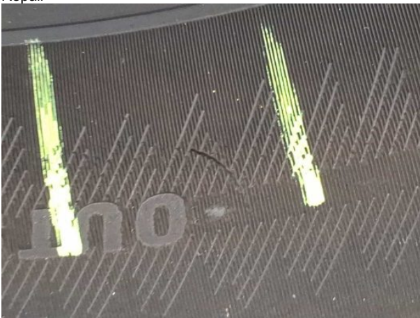
Beschädigung #13: 2.Radsatz: 1 Reifen - gebrochen / gerissen - erneuern
