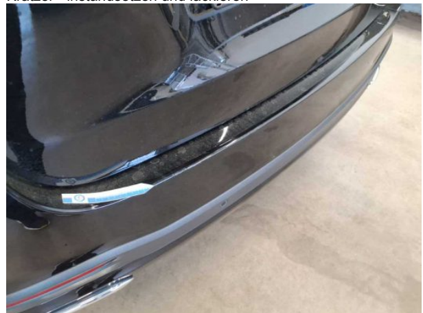
Beschädigung #16: Stossfänger hinten: Stossfänger hinten - Kratzer - instandsetzen und lackieren
