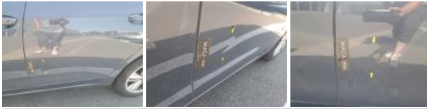
Door FL, Scratch(es), Paint
