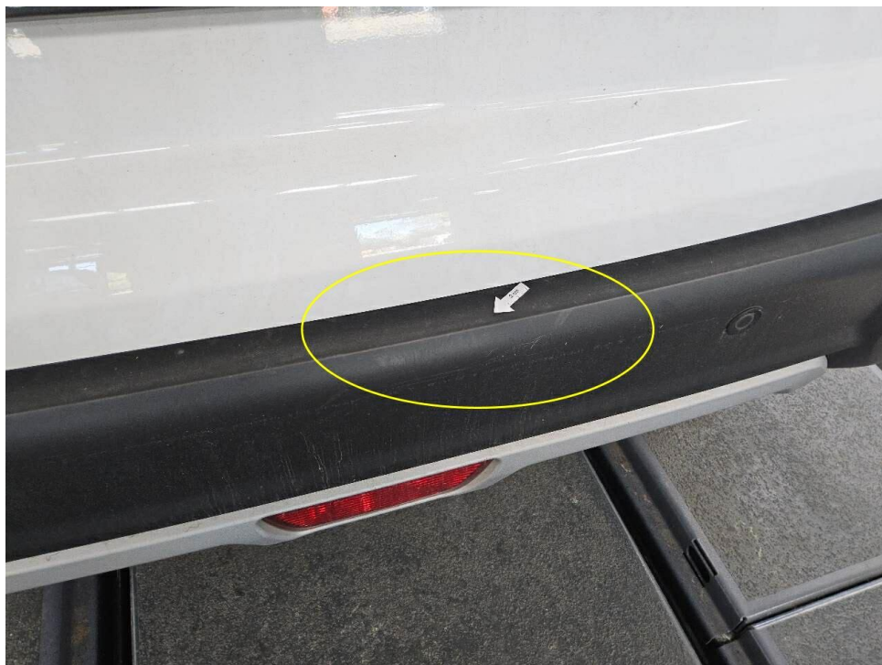
Bild 20 : Stoßfänger hinten, verschrammt
