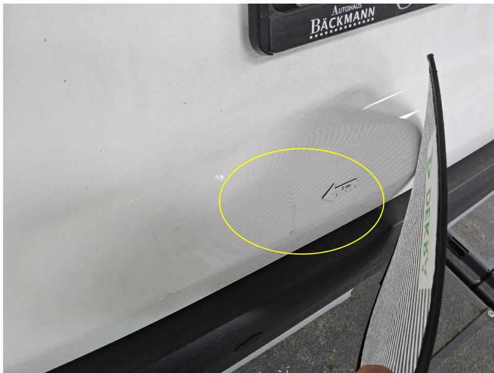
Bild 21 : Heckdeckel, eingedellt, drücken
