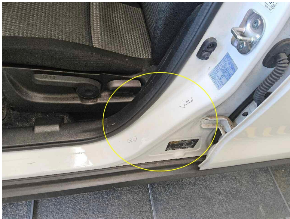
Bild 24 : Tür vorne links Einstieg, eingedellt, smart repair
