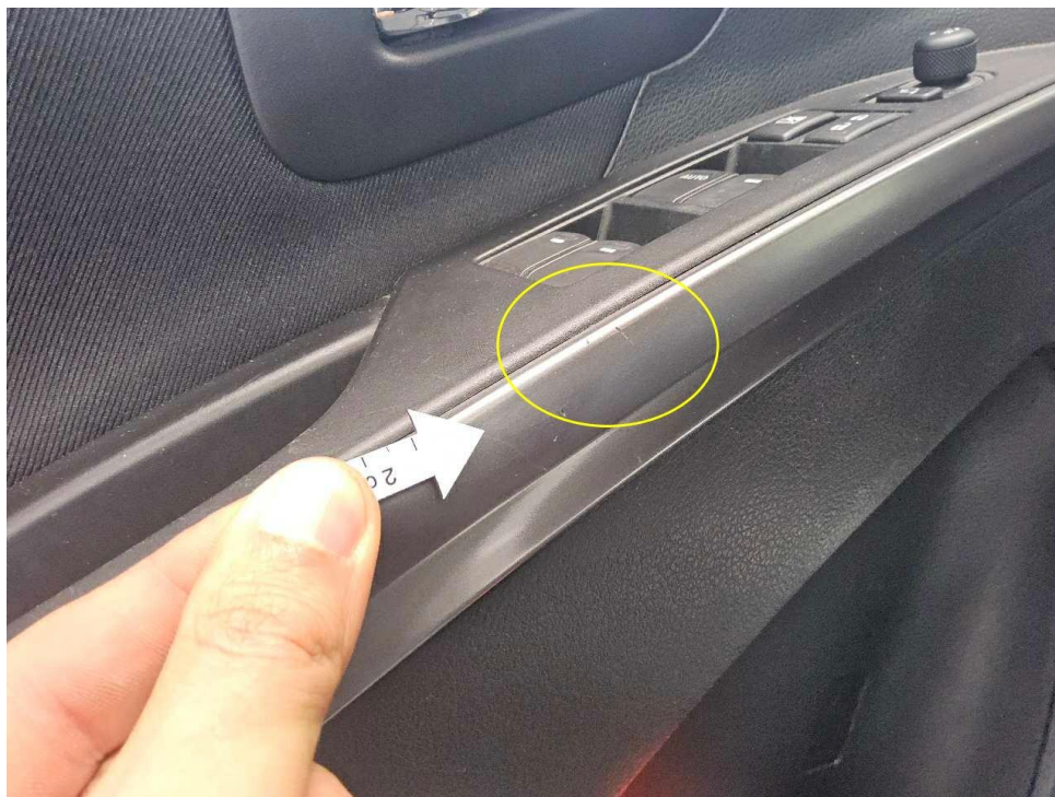
Bild 17 : Tür vorne links, Verkleidung verschrammt
