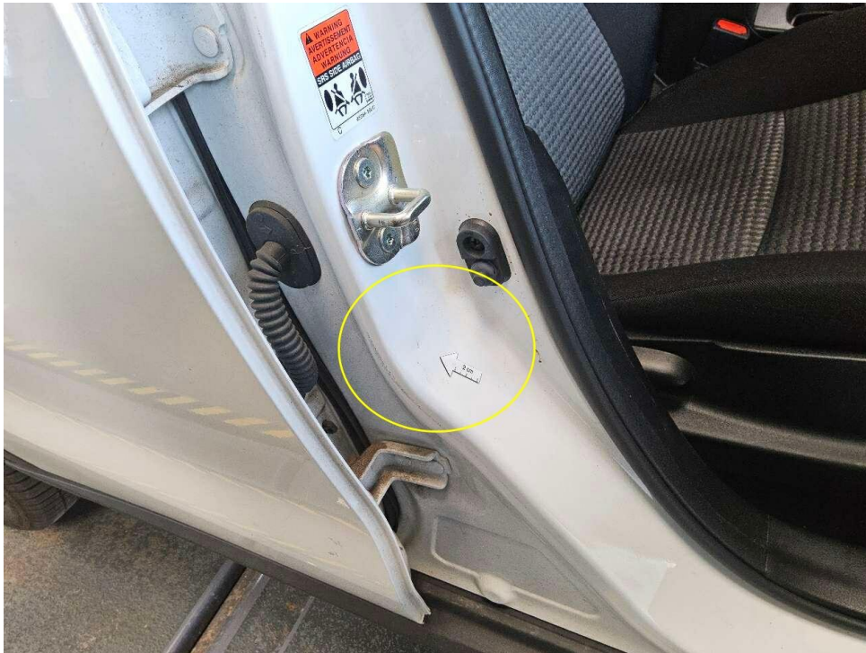
Bild 25 : Tür vorne rechts Einstieg, eingedellt, Gebrauchsspur
