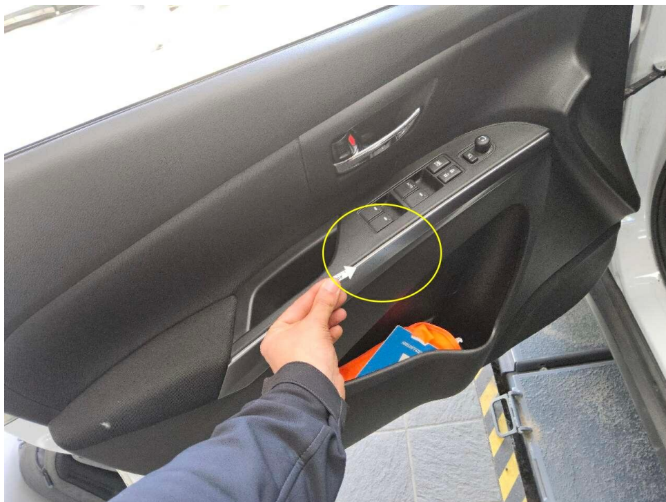
Bild 18 : Tür vorne links, Verkleidung verschrammt
