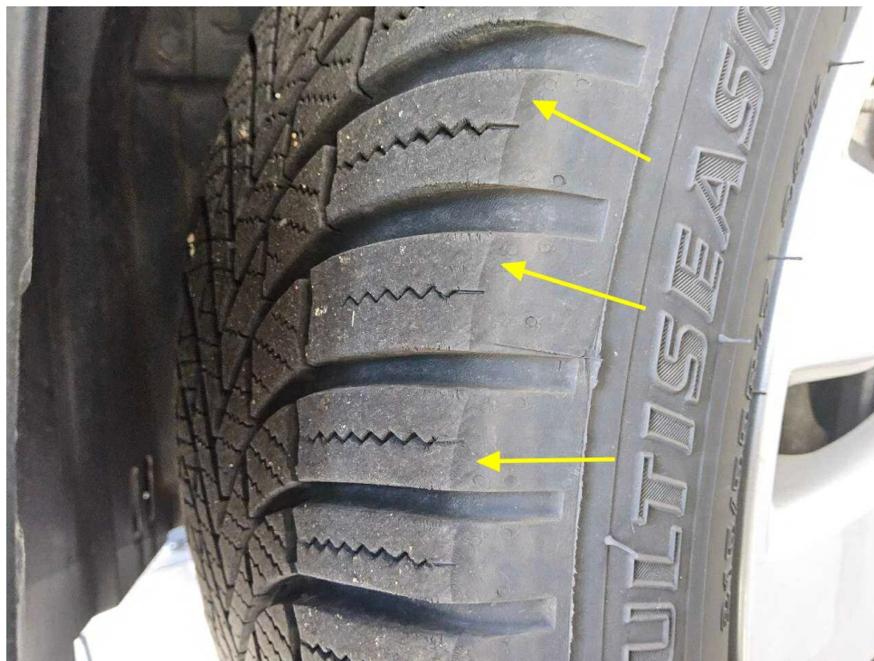
Bild 16 : Reifen vorne links und rechts, Altersrisse
