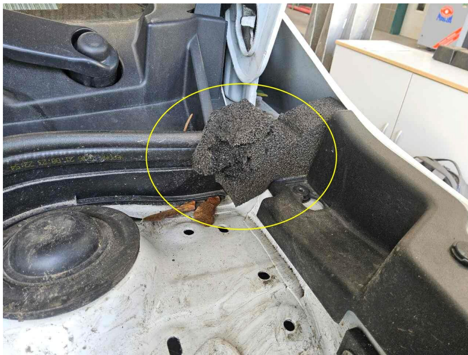
Bild 14 : Motorraum, Schaumstoff Tierbiss
