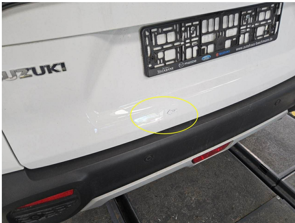
Bild 22 : Heckdeckel, eingedellt, drücken
