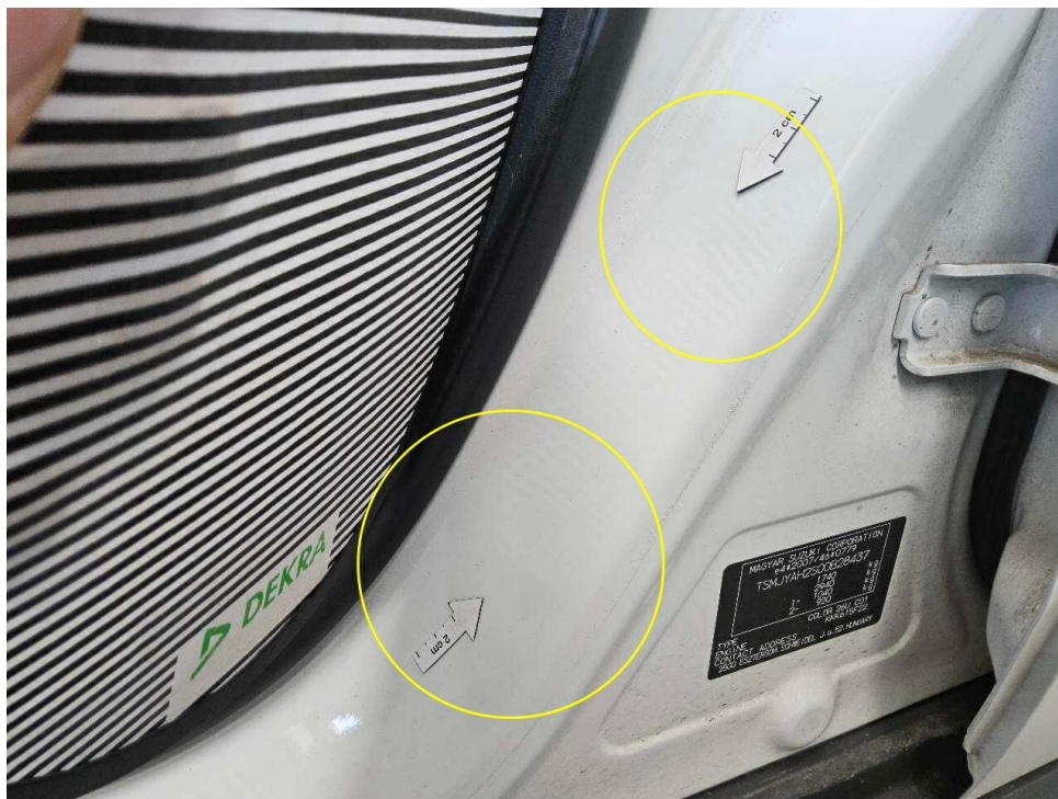
Bild 23 : Tür vorne links Einstieg, eingedellt, smart repair
