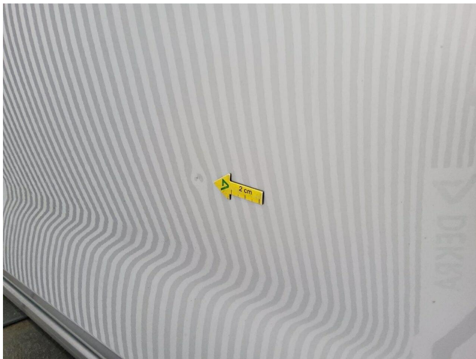
Bild 14 : Tür vorne links, eingedellt, drücken
