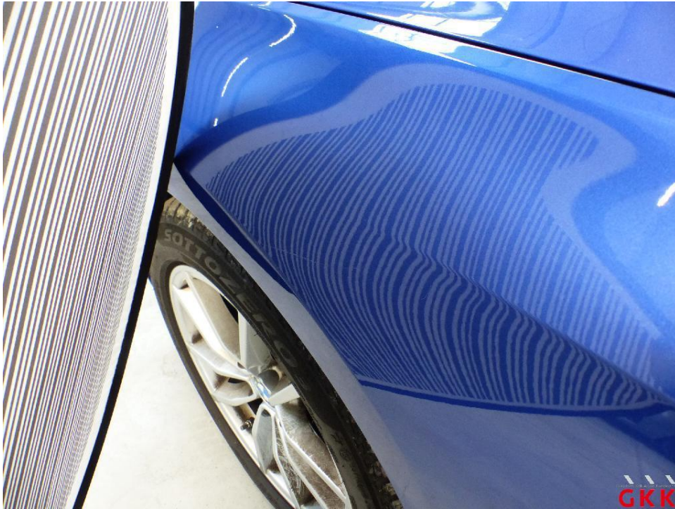
Bild 17 Kotflügel vorne links, verkratzt, lackieren
