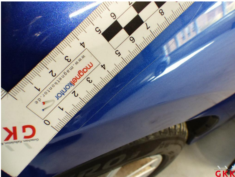
Bild 18 Kotflügel vorne links, verkratzt, lackieren
