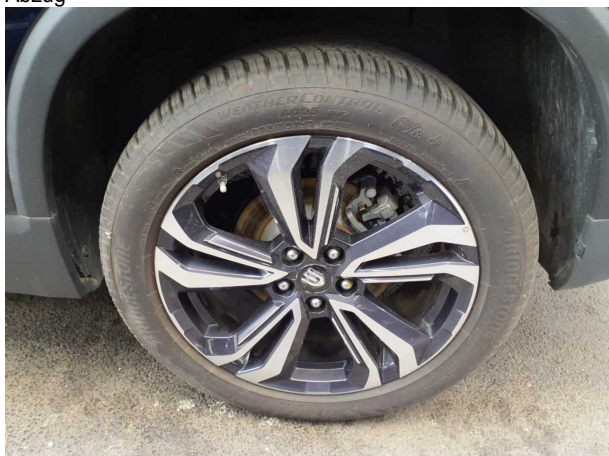
Beschädigung #6: Rad/Reifen: Felgensatz komplett - Korrosion - kein Abzug
