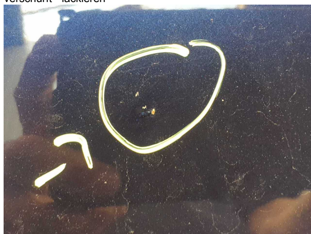
Beschädigung #13: Motorhaube: Motorhaube (Rost) - verkratzt / verschürft - lackieren
