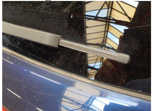
Beschädigung #8: Scheibenreinigung: Scheibenwischerblatt hinten - porös / rissig - erneuern
