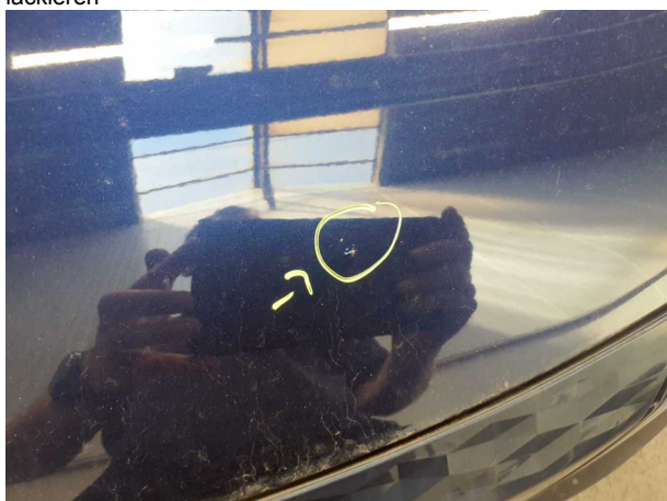
Beschädigung #13: Motorhaube: Motorhaube (Rost) - verkratzt / verschürft - lackieren
