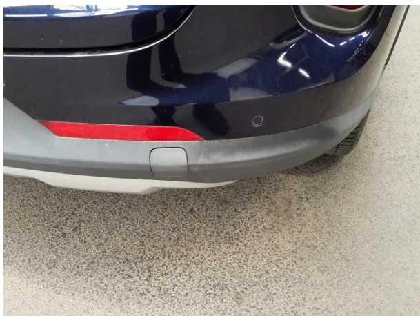
Beschädigung #3: Stossfänger hinten: Stossfänger hinten (unlackiert) (Ausgeblichen) - abweichend Auslieferungszustand - kein Abzug
