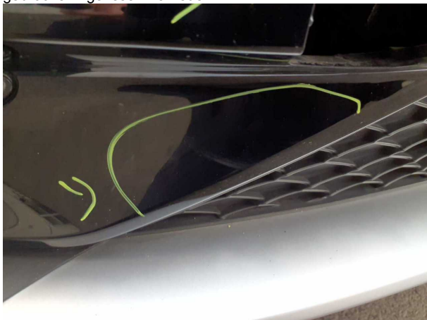
Beschädigung #10: Verkleidungen/Abdeckungen: Verkleidungen/Abdeckungen (Stoßfänger vorne rechts) - verkratzt / verschürft - Smart
