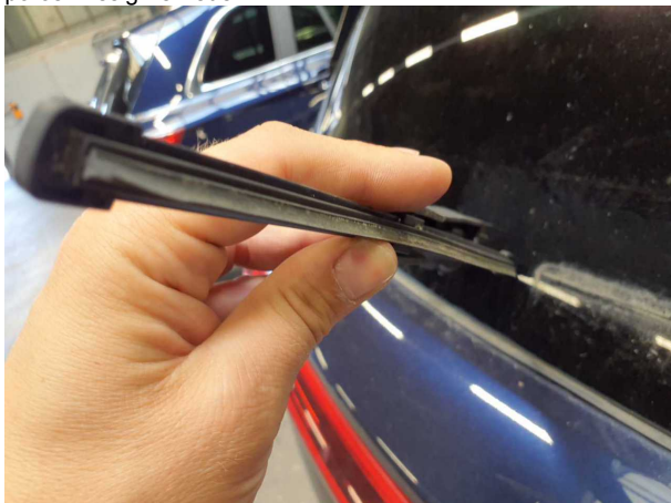
Beschädigung #8: Scheibenreinigung: Scheibenwischerblatt hinten - porös / rissig - erneuern
